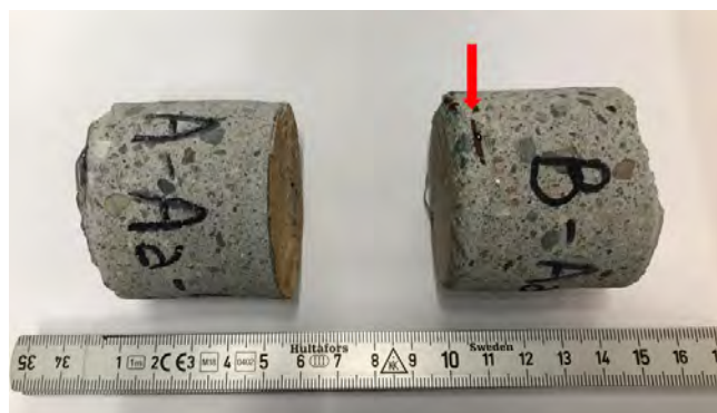
Figur 15: Sylindrar med Dramix RC-65/35-BN. A-Aa-4 eksponert i Grøft A med ytre jernrik utfelling og B-Aa-4 eksponert i Grøft B med ytre jern- og manganrik utfelling. Bare B-Aa-1 viste stålfiberkorrosjon under eksponeringsflata (raud pil ca. 5 mm).
