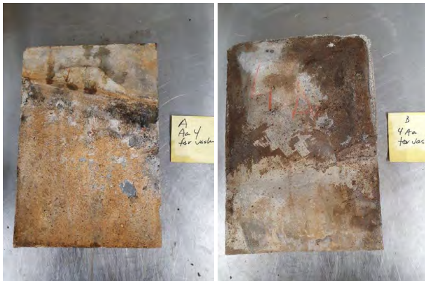
Figur 3: Eksempel på fiberarmerte plateprøver frå Grøft A (venstre) og Grøft B (høgre) laga med Ålborg sement og masseforhold = 0,80 (før utboring). Det blei bora ut to sylindrar ( \Phi = 50 mm) av kvar plate med reservert plass for utboring etter vidare eksponering på to seinare tidspunkt.
