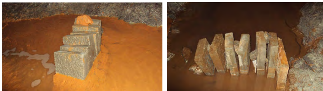
Figur 4: Foto av plateprøver i Grøft A (venstre) og Grøft B (høgre) frå juni 2010. Plateprøvene vist på bildet ( v/b = 0,40 og 0,45 , med PP-fiber og stålfiber) blei undersøkte i etatsprogrammet Varige konstruksjonar. Prøvene for testing av direkte eksponerte fibrar og plateprøver med v/b = 0,80 i denne rapporten er plasserte i same område og er fullstendig neddykka. Alle prøvetypane er framleis representerte i grøftene for langtidseksponering.
