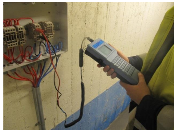
Figur 64B. Kontrollmätning av skyddsförmågan med extern referenselektrod, Ag/AgCl. (t v) och mätning av de ingjutna anodernas strömavgivning med nollresistans-ampremeter (t h)
