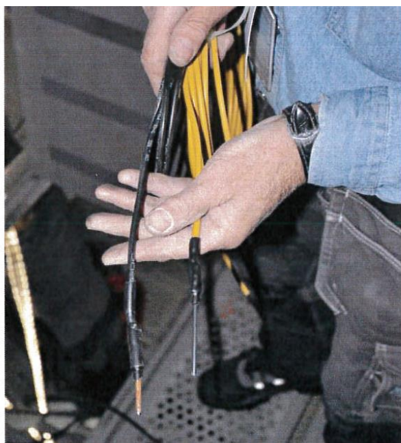
Figur 43B. Utseendet hos titanelektrod (höger) och mätelektrod av kolstål (vänster)
