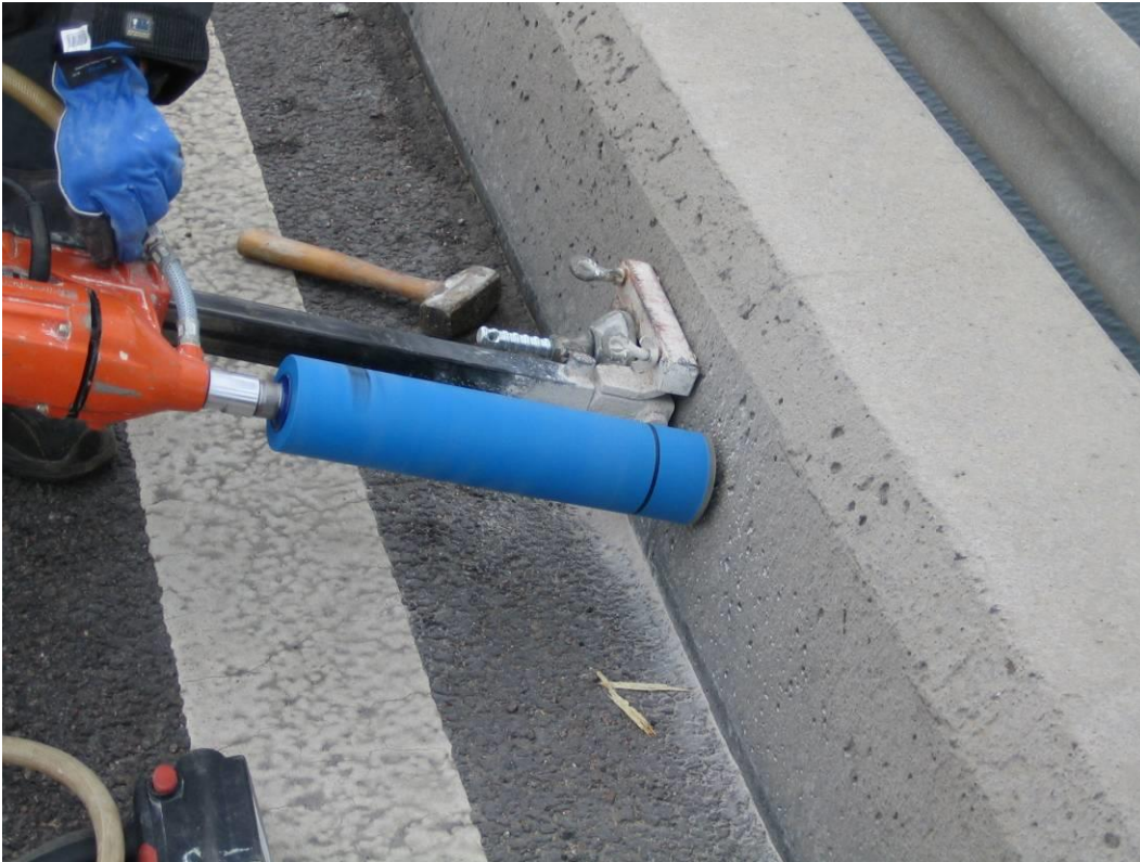
Figur 19B. Termiskt sprutat zinkskikt efter 11 års exponering på Ölandsbron.
