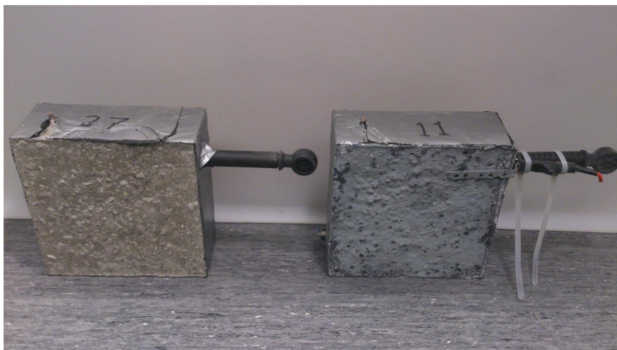
Figur 61B. Provblock 11 med tillhörande referens 27. Dessa provblock har varit placerade i 97 % RF
