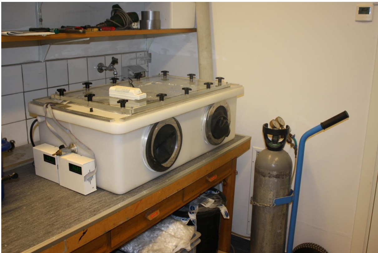
Figur 52B. CBI:s CO 2 -box som användes vid karbonatiseringen av provblocken.
