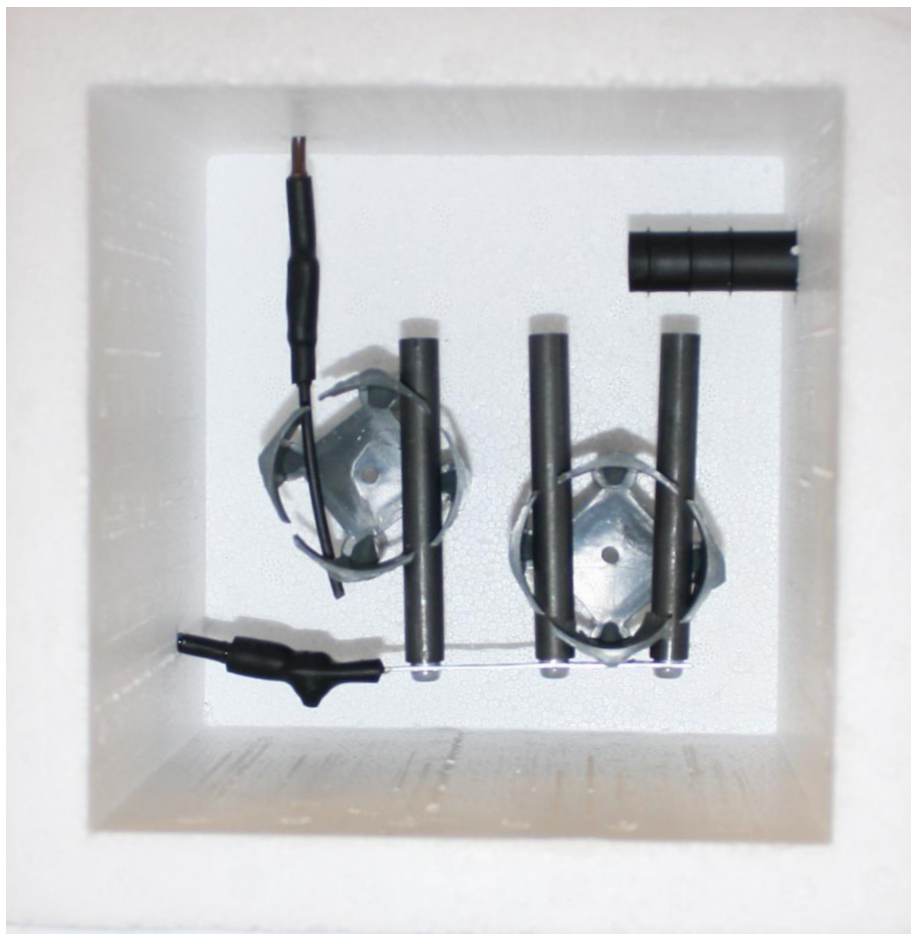
Figur 51B. Foto av provblocket innan gjutning. Frigolitformar som normalt används för att gjuta 150mm kuber användes för tillverkningen.
