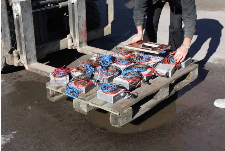
Figur 53B. Provblocken innan sprutning. Den röda kabeln ansluts till zinkskiktet i samband med sprutningen.
