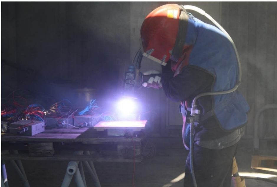
Figur 54B. Ljusbågs-sprutning av provkropparna.
