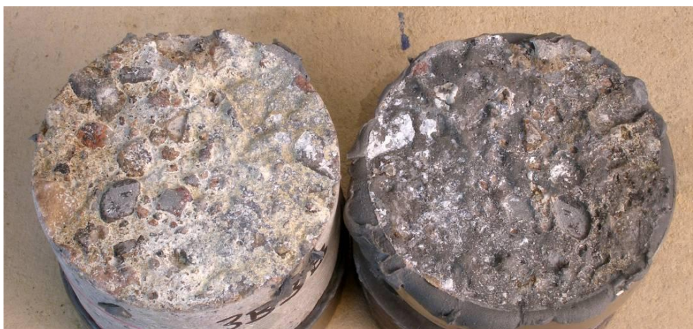
Figur 39B. Vidhäftningsprov 3B under vattenytan.
