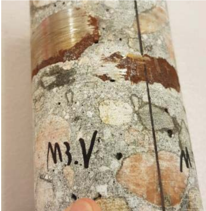
Figur 1 M3 etter 5 måneder pakket i plast på kjøll. Fukt rundt flere tilslag som antageligvis er ASR.
