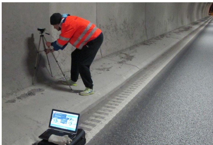
Figur 5 Oppstilling av utstyr for måling av refleksjonsfaktor, før vask i april 2013. Foto: Eva Rodum, Statens vegvesen.
