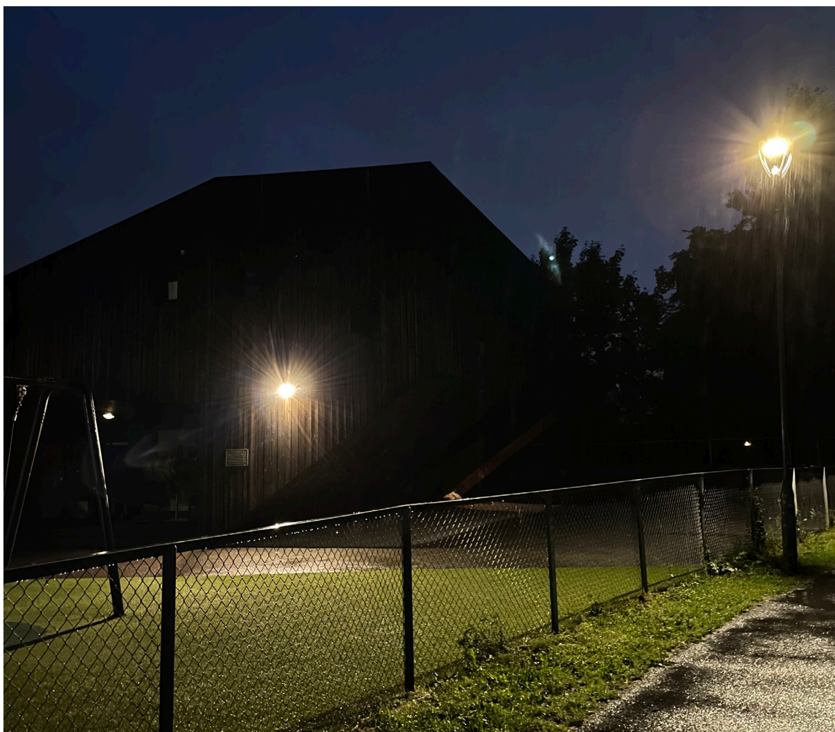
Foto 3: Utendørsbelysning ved en barnehage i Oslo. Belysningspunktene er ikke skjermet, og har en delvis blendende effekt. Foto: Idunn Saltnes Skjerdingsstad
