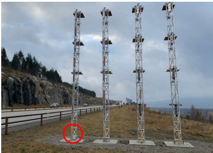
Figur 14 Master med prøveutstyr/-materiale ved E6 på Espa. Rød ring viser lokalitet av prøve hvis kloridprofil er vist i Figur 15. Denne masta, nærmest vegen, er plassert ca. 4,5 m fra hvit kantlinje. Foto: Trond Lorentzen, Statens vegvesen.
