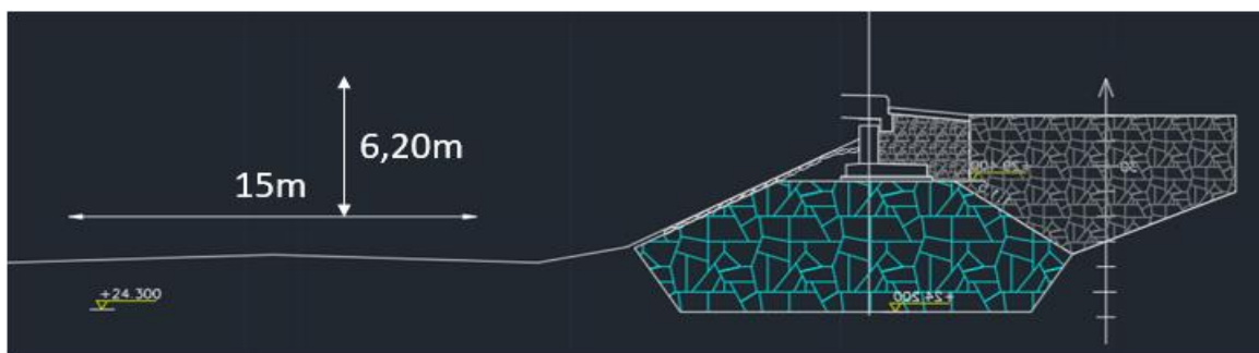
Figur 8 Terrengprofil m/ høyde- & lengdekrav
