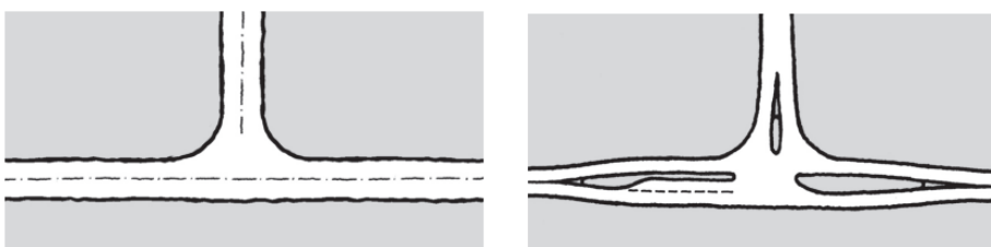
Figur 19: Ukanalisert T-kryss og kanalisert kryss [53].
