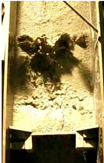
Figur 7.10: Masser som passerer 4 kjebler og fanges av 4-spalters kontrolldam, foto: Fiskum (2012).
