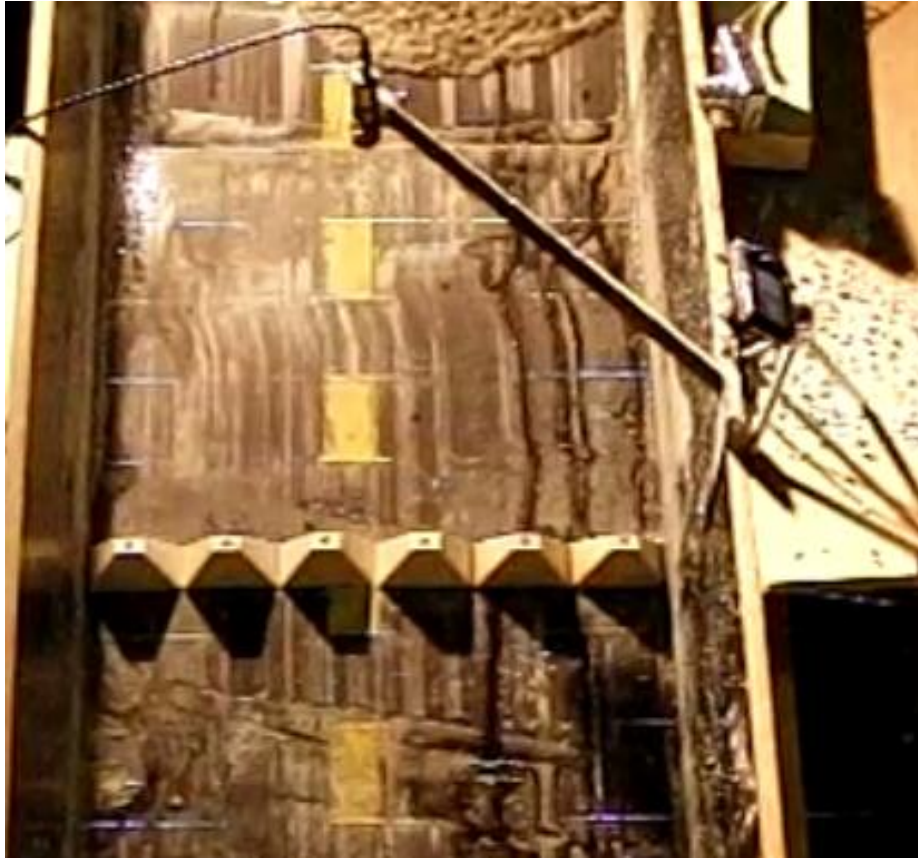
Figur 5.14: Oppsett av kjeglene i modellen, foto: Fiskum (2012).
