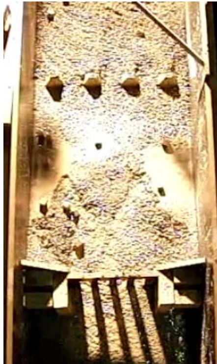
Figur 7.11: Masser etter at skredet har stoppet for test 31, foto: Fiskum (2012).
