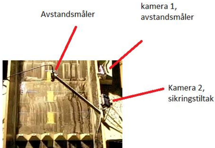
Figur 6.2: Oversikt over måleutstyr rundt sikringstiltaket, avstandsmåler og kamera oppsett. Foto: Fiskum (2012)
