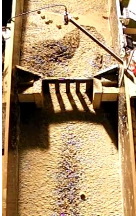
Figur 7.6: Masser oppstrøms for kontrolldammen etter at skredet har passert og stoppet, foto: Fiskum (2012).
