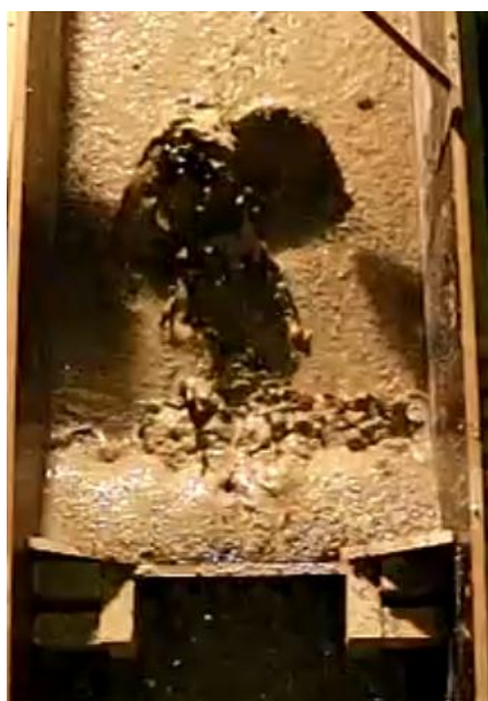
Figur 7.9: Masser som i test 29 blir "kastet" opp i luften av kjebler og deretter stoppet av 4-spalters kontrolldam, foto: Fiskum (2012).
