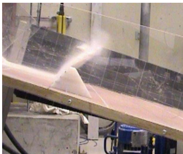
Figur 7.23 Sammenstøt med 60RV4-150-90. Vollen er plassert 150 cm nede i renna.
