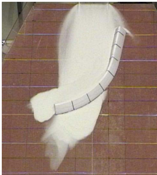
Figur 7.26 60° buet voll som viser en tydelig frontmasse "stikker" som ikke tatt igjen av de bakre massene som går over vollen
