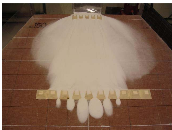
Figur 7.14 Avsetning av masse ved bruk av 60K2-137 og varierende plasseringen av den andre raden, 45K2. Her er rad 2 plassert ved 160, 180 og 200
