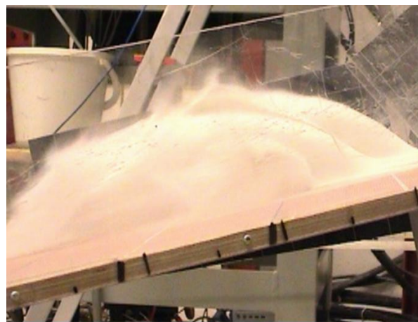
Figur 7.11 Kast av masse over plogformede rektangulære kjegler
