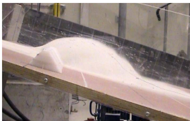
Figur 7.19 Massen som kastes over 60° rett voll normalt på strømningsretning. Kastelengden er noe lengre enn ved bruk av 90° voll.
