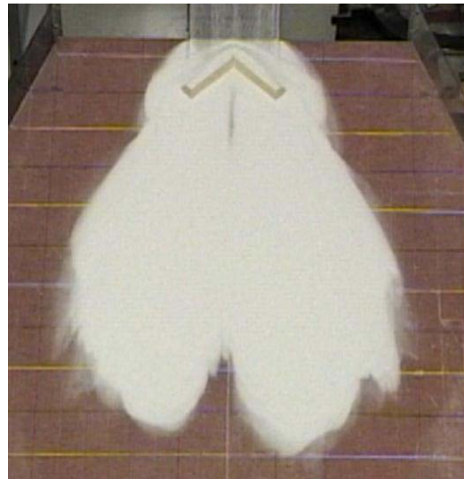
Figur 7.17 Plogvoll konsentrerer massene.
