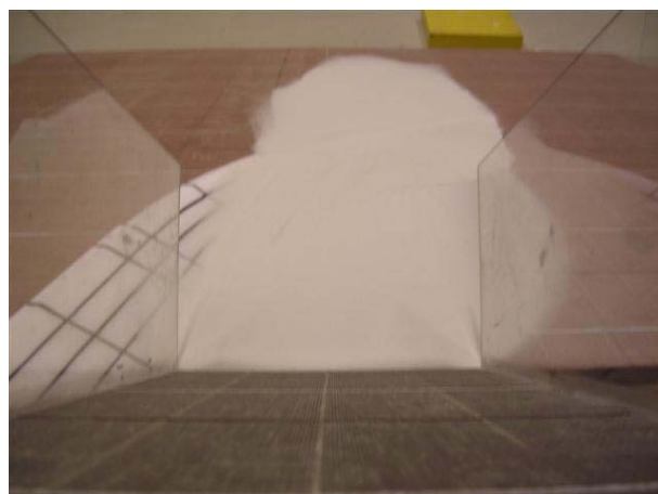
Figur 9.3 Strømning av masse over 30BV4. Den reelle vinkel på vollen er avhengig av plassering i renne.
