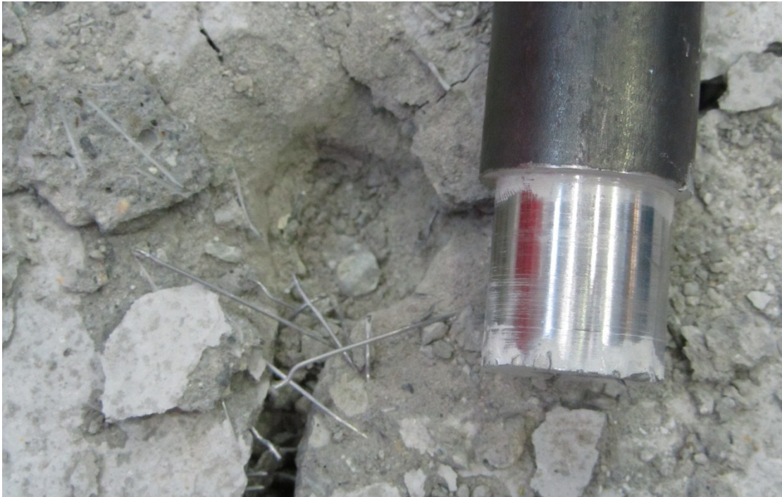
Figur 4.15: Pelspiss mot fiberbetong
