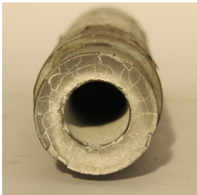
Figur 5.8: Deformasjon av spiss nummer 1
