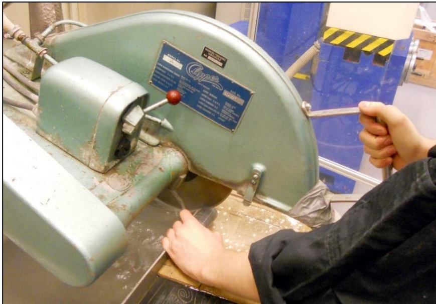
Figur 3.10 Saging av kjerneprøver (Foto: Gunnar Visnes).
