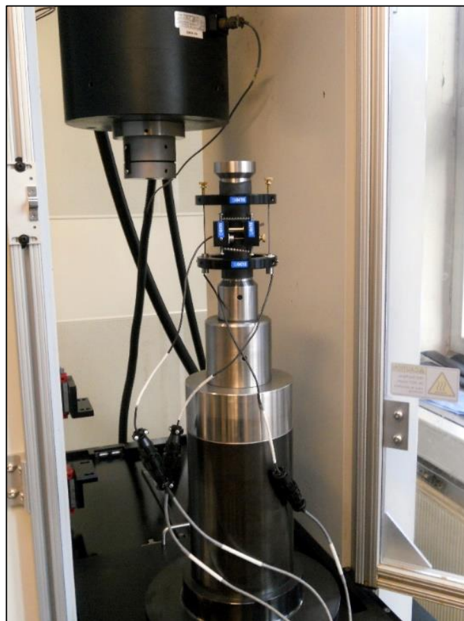
Figur 3.15 Trykkcelle for einaksialt trykkforsøk (Foto: Lars Jørgen Hole).
