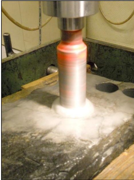
Figur 3.8 Boring av kjerneprøver i laboratoriet (Foto: Lars Jørgen Hole).
