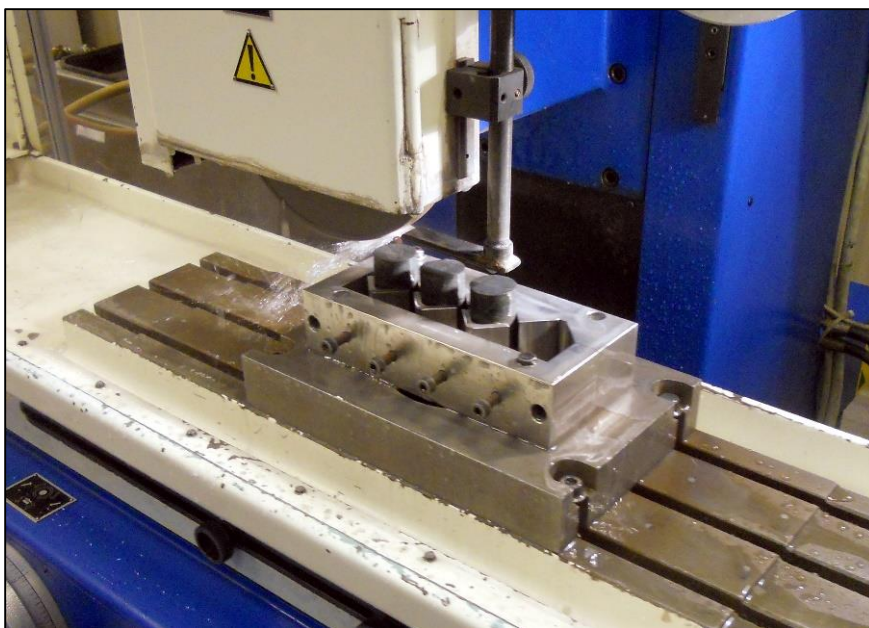
Figur 3.11 Sliping av kjerneprøver (Foto: Lars Jørgen Hole).
