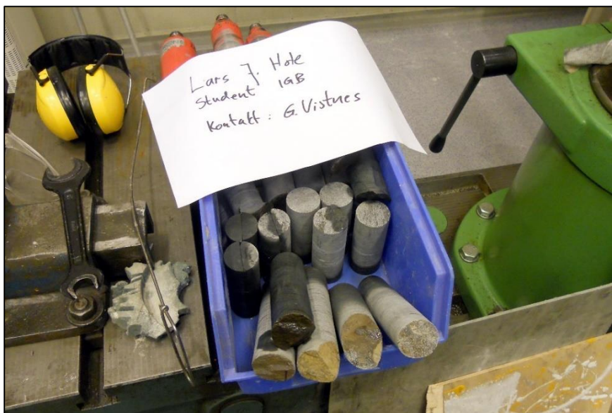
Figur 3.9 Ferdig bora kjerneprøver (Foto: Lars Jørgen Hole).
