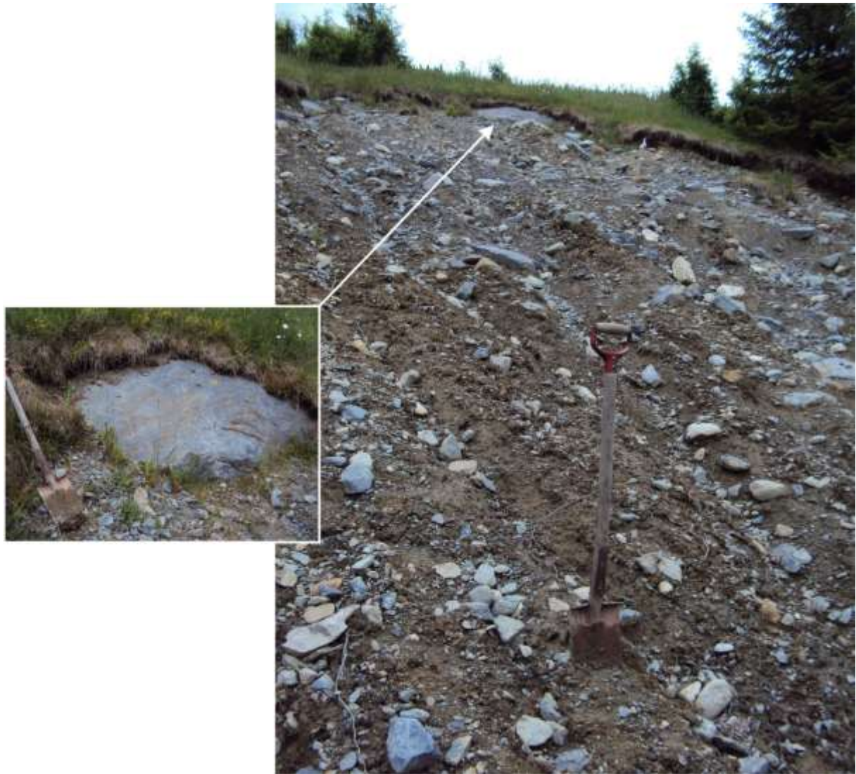
Figur 8.32 Oversikt over jordskredets bruddsone. Blokk eller grunnfjell er blottlagt på SØ-siden av bruddkanten og denne inneholder to sprekkesett.
