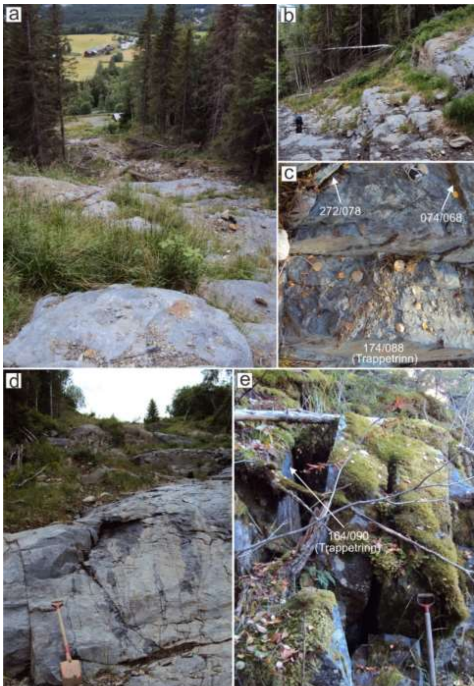
Figur 8.34 a) Utsyn nedover skredløpet fra den øverste store grunnfjellsblotningen, b) tydelig trappetrinnmønster dannet av samspill mellom sub-horisontal foliasjon og et sub-vertikalt sprekkesystem, c) tre sprekkesett i grunnfjellsblotningen. Sprekkesettet med orientering 174/088 danner et trappetrinnmønster i blotningen, d) utsyn fra det blottlagte grunnfjell og oppover skredløpet og e) blotning av grunnfjellet rett SØ for øverste store grunnfjellsblotningen i skredløpet. Her kommer særlig ett sprekkesett tydelig fram, med orientering 164/090. Dette tilsvarer sprekkesettet som danner trappetrinnmønsteret i skredløpet.
