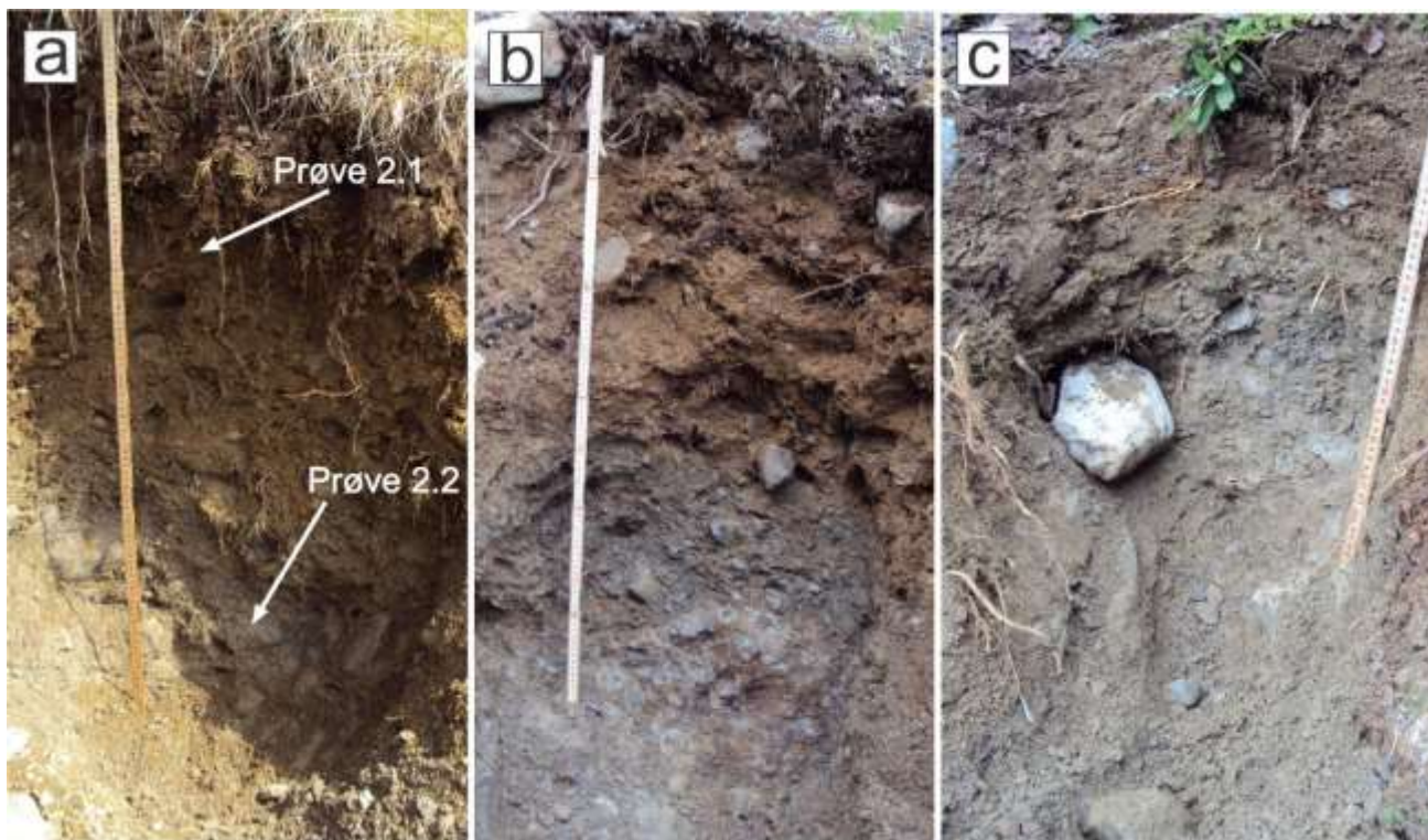
Figur A4 Profiler fra morenen langs kanten av skredløpet. a) Profil 2.1, SØ i bruddkanten, hvor sedimentprøve 2.1 og 2.2 ble tatt av henholdsvis øvre og nedre del, b) Profil 2.2, SØ for øverste store grunnfjellblotning, hvor sedimentprøve 2.3 ble tatt og c) profil 2.3, NV for øverste store grunnfjellblotning hvor sedimentprøve 2.4 ble tatt.
