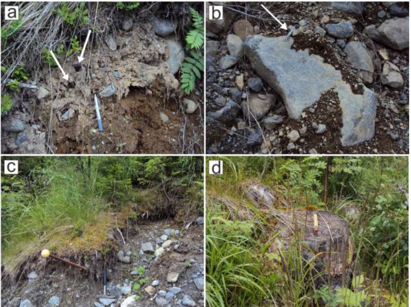
Figur 8.19 Andre detaljer fra skredområdet. a) Små hull i gjenværende løsmasser (eksempler vist med hvite piler), b) typisk størrelse på klaster og blokker i skredaret (hvit pil viser kulepenn til skala), c) rotert grensestolpe i kanten av skredet og d) avkuttede trestammer fra skoghogst.
