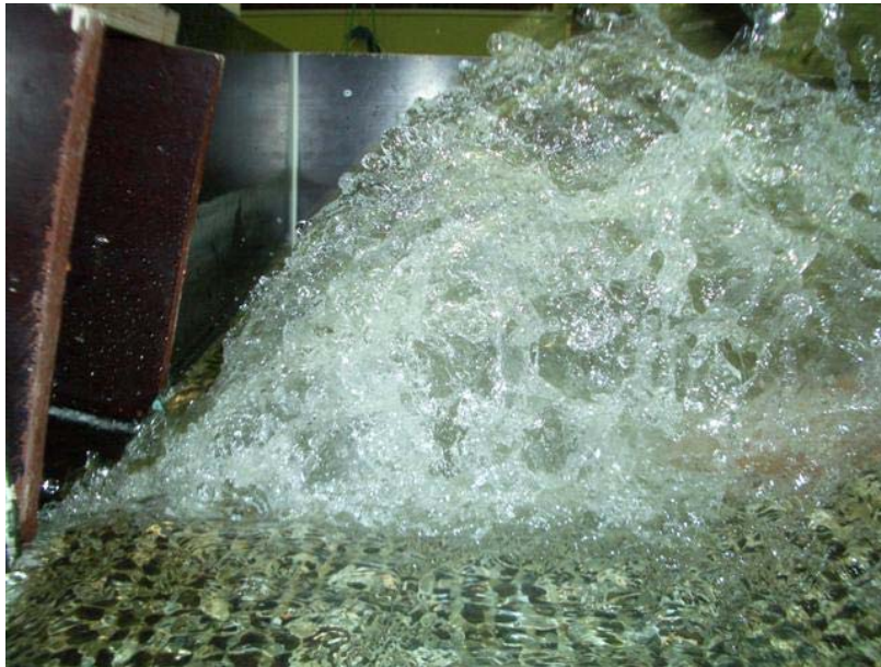
Figur 2-4 Framprovosert vannstandssprang ved bruk av bremseklosser
