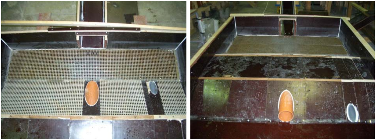
Figur 4-34 Hovedløp og reserveløp for henholdsvis 30 cm og 60 cm basseng.
