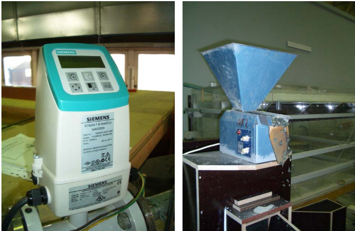
Figur 3-7 Utstyr brukt under forsøk. Vannføringsavleser i bildet til venstre og vibratormaskin i bildet til høyre
