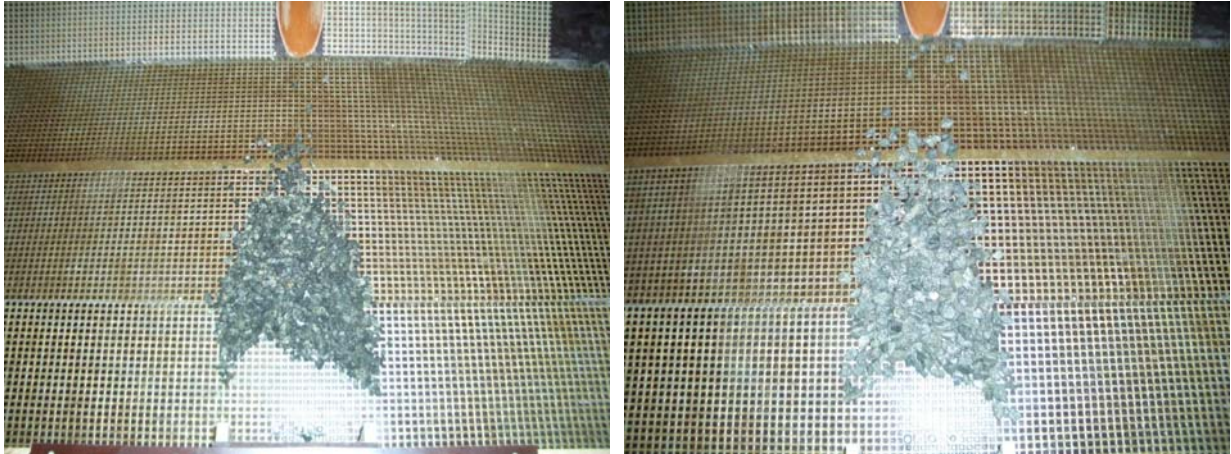
Figur 4-8 Oppsett av 90 cm basseng med bremseklosser. Vassfjell 8-11 i bildet til venstre og Vassfjell 16-22 i bildet til høyre
