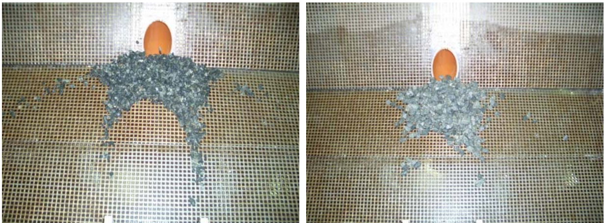
Figur 4-15 Oppsett av 60 cm basseng uten bremseklosser. Vassfjell 8-11 i bildet til venstre og Vassfjell 16-22 i bildet til høyre
