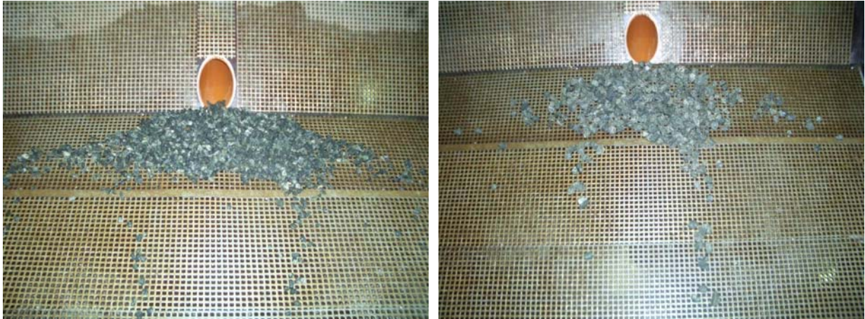
Figur 4-16 Oppsett av 90 cm basseng uten bremseklosser. Vassfjell 8-11 i bildet til venstre og Vassfjell 16-22 i bildet til høyre
