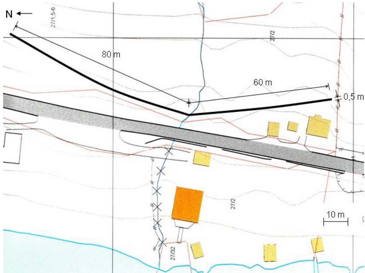
Figur 6-42 Skisse av terrengrøft og utsprenging av bekkeløp
