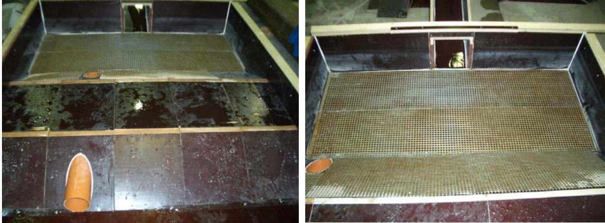
Figur 4-21 Forskjøvet hovedløp med 60 cm basseng. Bildet til venstre viser lav fylling og bildet til høyre viser høy fylling.
