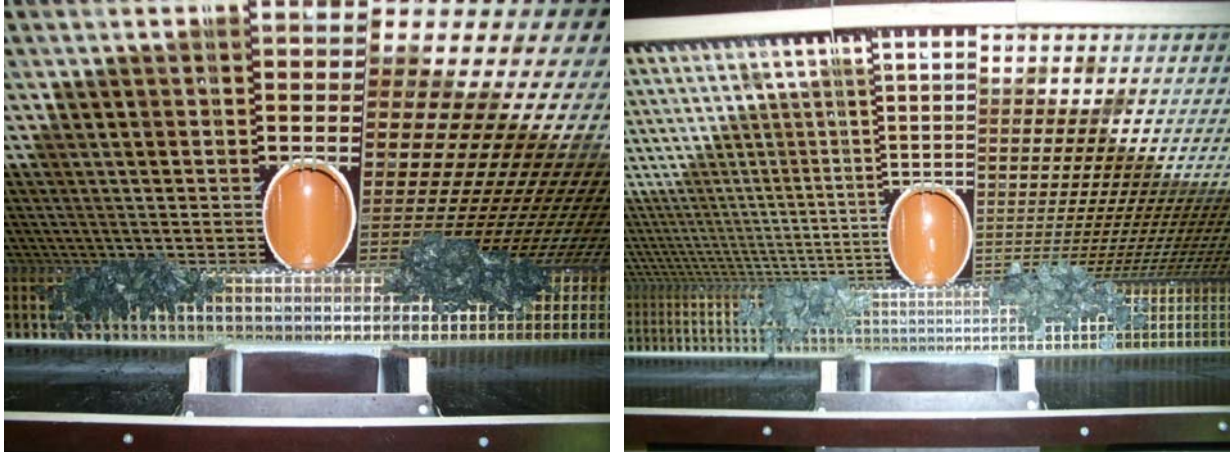
Figur 4-12 Oppsett av 10 cm basseng uten bremseklosser. Vassfjell 8-11 i bildet til venstre og Vassfjell 16-22 i bildet til høyre
