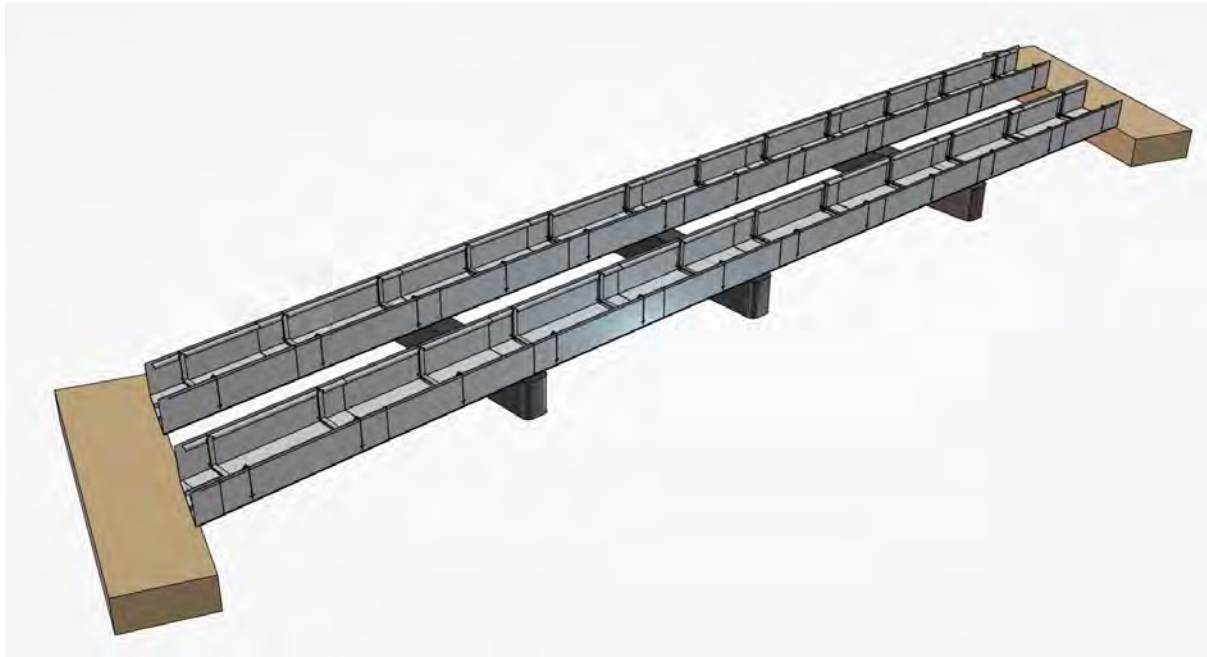
Figur 25: Montering av stålkasse under sandwich
