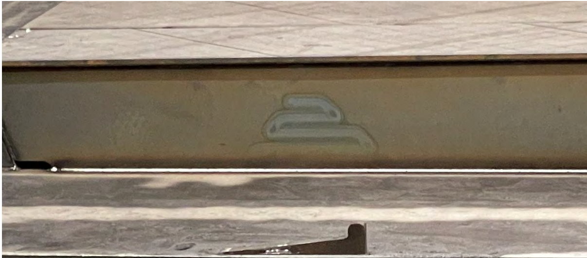
Figur 28 Laser Hybrid sveis med full gjennombrenning
