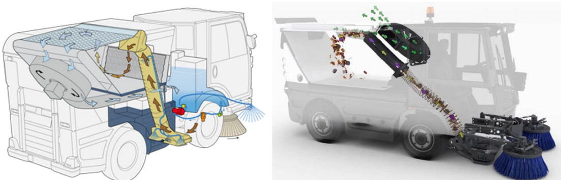
Figur 4.1.4 Prinsippskisse for små og mellomstore feie-/oppsugsmaskin (Sigurd Stave Maskin AS og Aebi-Schmidt Group)
