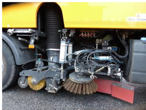
Figur 4.1.5b Eksempler på frontsystem med styrbar frontbørste med vanddyse på bom samt feiesystem midtmontert på bilen (Brynhild Snilsberg)
