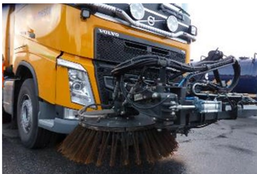
Figur 4.1.5b Eksempler på frontsystem med styrbar frontbørste med vanddyse på bom samt feiesystem midtmontert på bilen (Brynhild Snilsberg)
