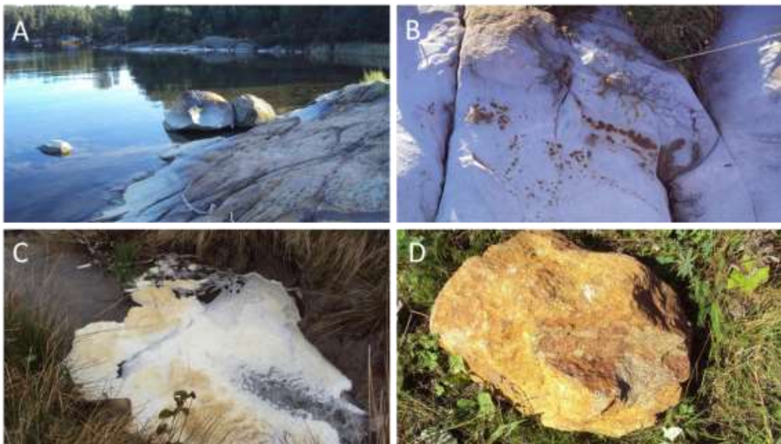
Figur 20: A og B, utfelling av aluminiumrike harde skorper på badeplass i Kaldvellfjorden. C, utfelling av aluminiumrikt skum i Stordalsbekken nedstrøms deponi M15/16. D, rusta svovelførande gneis frå deponiet med typisk gul til gulbrun forvitring. Foto: Per Hagelia.
