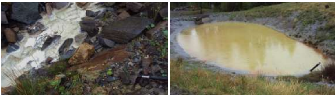
Figur 28: Venstre; Kvite utfellingar av Al-rikt skum og relativt faste skorper på stein i bekken ved lok. M20-1. Høgre; reinsbasseng med pukk og finare fraksjonar av marmor.
