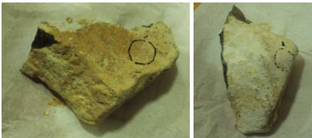
Figur 41: Prøve «M20-Al-skorpe» blei undersøkt ved XRD, SEM og ICP-MS. Foto: Per Hagelia.
