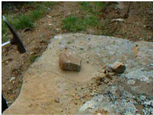
Figur 3: Eksempel på kraftig fragmentering av forvittra gneis. Stein som i utgangspunktet virka sterke blei etter eit par slag med hammaren svekka og kunne då malast opp til pulver med handmakt. Foto: Per Hagelia.
