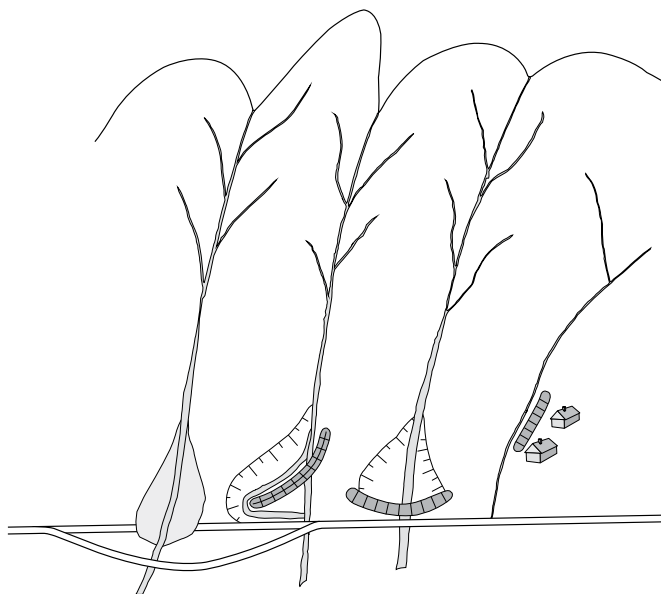
Figur 6.1 Prinsipper for sikring av veg og jernbaner mot flomskred og sørpeskred.
