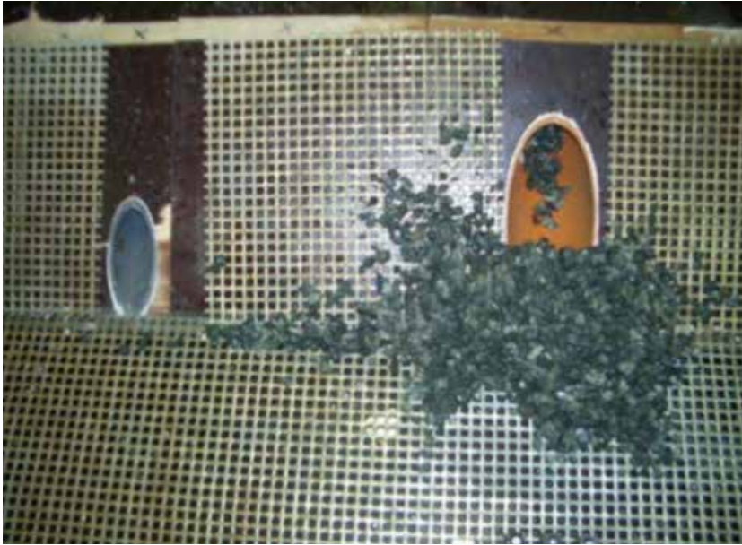
Figur 6.37 Resultat av modellforsøk med 30 cm (6 m) bred grøft og reserveløp 50 cm (10 m) til side for hovedløpet.
