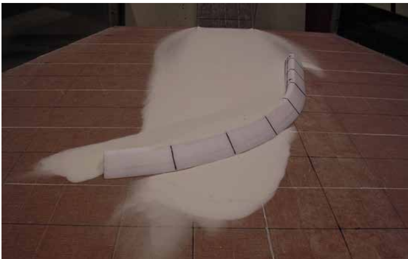
Figur 6.17 Modellforsøk med buet voll med helling 60°. Den fremre bølgefronten har passert vollen, mens vollen har styrt de bakre massene tilfredsstillende, Brateng (2005).
