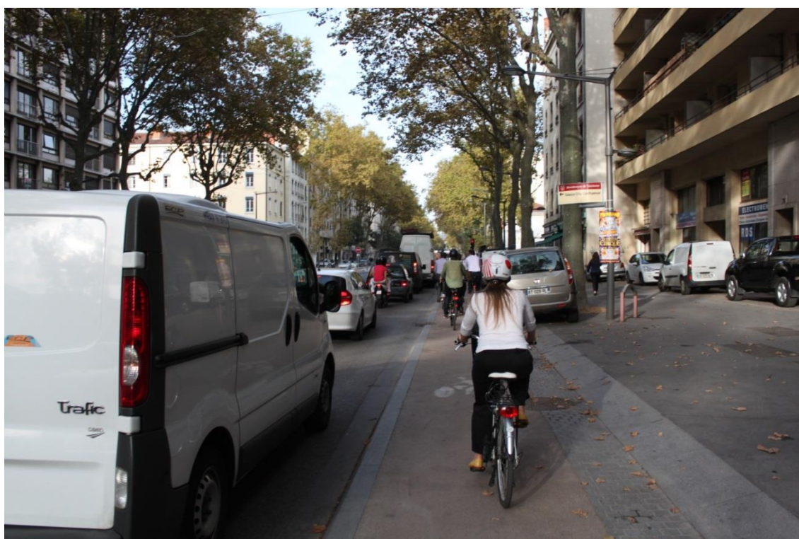
Figur 8: Mye trafikk i sentrumsgatene. Her er eksempel på sykkelveg med kantstein mot kjørebanelen.
