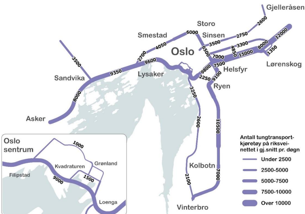
Figur 3-18 ÅDT for tungtrafikk på riksveinettet, omregnet fra prosent tungandel (kilde: Trafikkdata.no.). (Kart: Asplan Viak AS).
