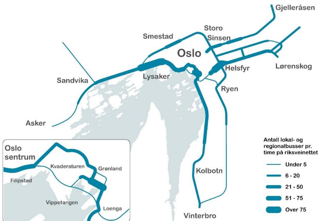
Figur 3-15 Frekvens for busstrafikk i rushtiden på riksveinettet i Oslo-området (Asplan Viak AS).
