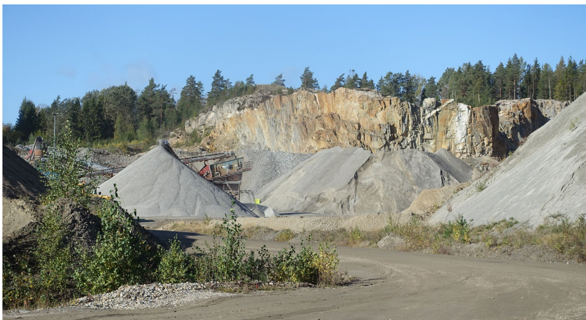
Figur 1 Sand og fine mineralpartikler i produksjonsanlegg for pukk i et steinbrudd. Foto: Erik Solfeld.
