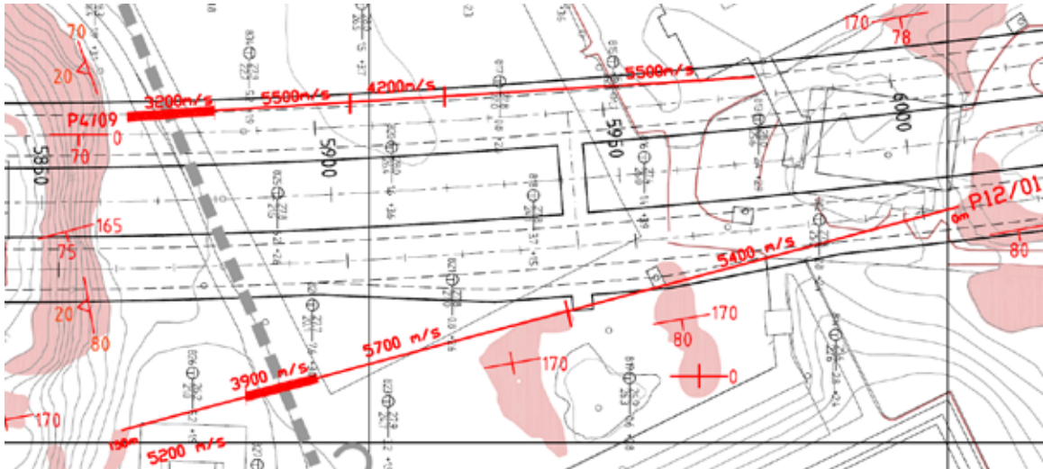
Figur 2.5 Utsnitt av geologisk kart som viser eksempel på hvordan seismiske profilinjer kan presenteres, her i rødt, med angivelse av seismisk hastighet. Lavhastighetssoner er gjerne forsterket med tykkere strek. I tillegg vises her berg i dagen som røde felt (bergblotninger) med strøk/fall av sprekker og foliasjon, samt totals-enderinger (Ringveg Vest Bergen). [11]
