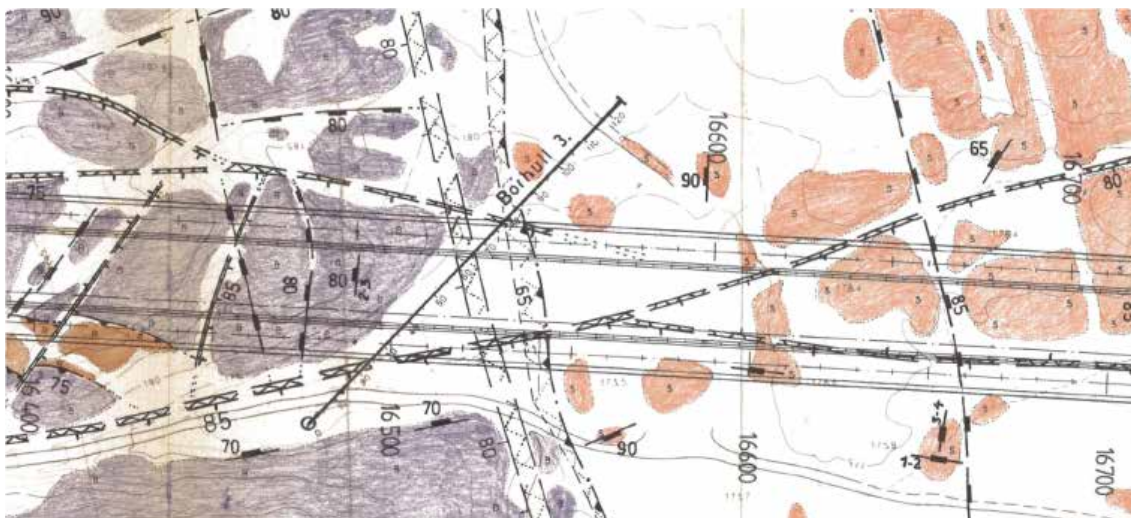
Figur 2.12 Utsnitt fra geologisk kart med eksempel på hvordan felldata kan rapporteres og samtidig vise materialets begrensninger. Fargene representerer ulike bergarter, og er tegnet der det er bergblotninger. Svakhetssoner, oppsprekking samt kjerneborehull er inntegnet. I tillegg kommer tegnforklaring [47]
