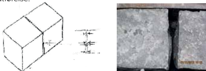
Figur 5.3 Prinsipp for knassetting (illustrasjon og bilde: René Kierstein)
