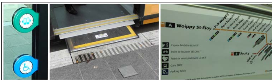
Figur 14 Dørknapper, rampe som styres av sjåføør fra førerplassen, og innvendig linjekart som på T-baner
