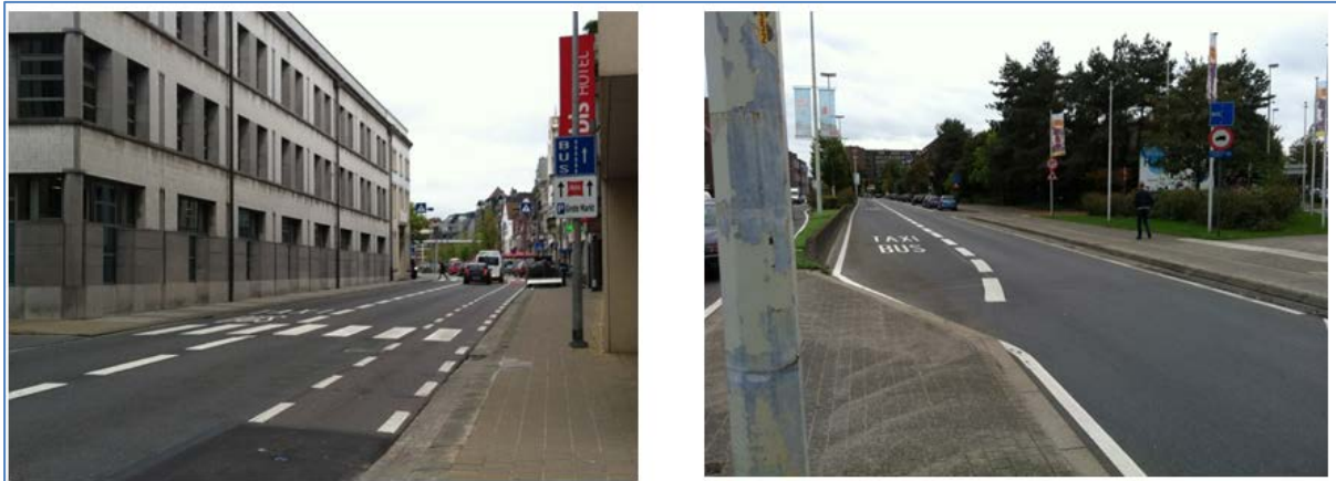
Figur 26 Sykkelfelt, bilkjørefelt og kollektivfelt i bygate. Oppmerking av start av midtstilt kollektivfelt
