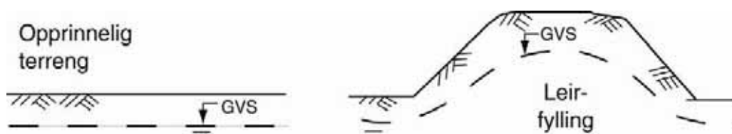
Figur 14.11 Oppfukning av leirfylling.
