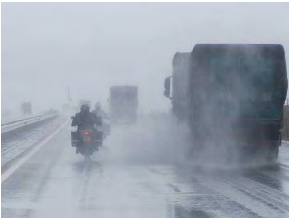
Figur 6-25 Oppvirvling fra vegoverflate
