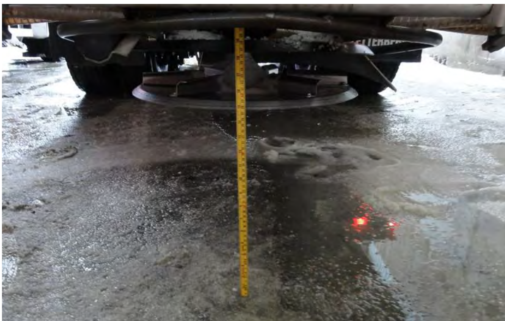
Figur 7-8 Måling av høyde på spredertallerken (Foto: Dagfin Gryteselv, Statens vegvesen)
