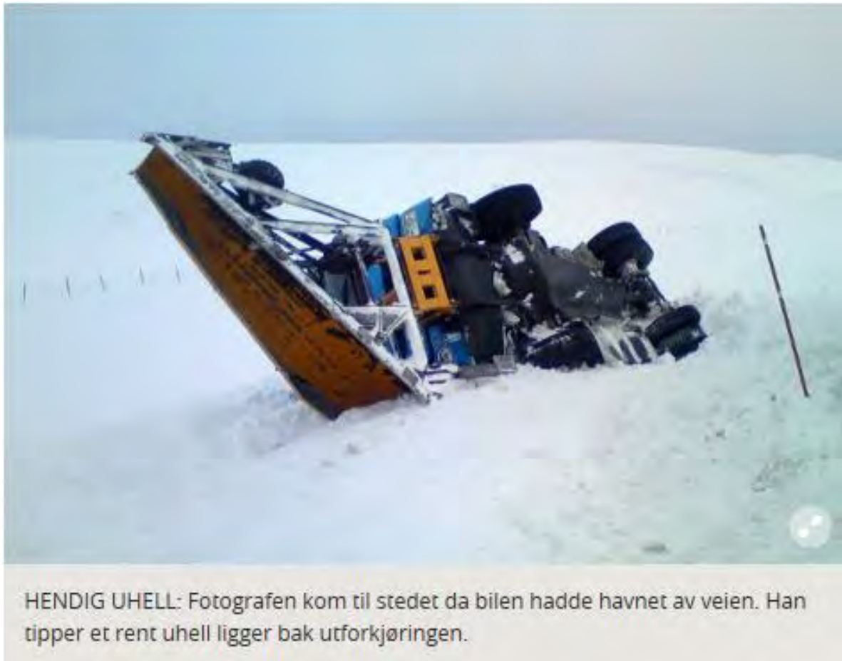
Figur 4-89 For høy brøyte hastighet (Foto: Ukjent, kilde: iFinnmark 23.04.15)
