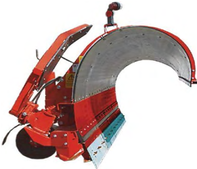
Figur 4-36 Snøstopper montert på brøyteplog (Foto: Rossøplog)
