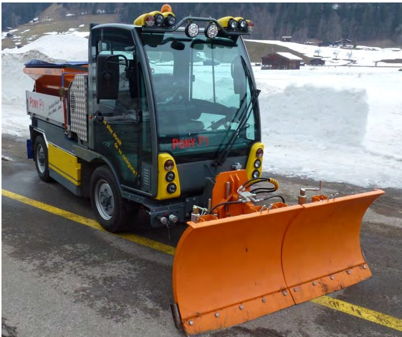
Figur 4-55 Eksempel på plog egnet for arbeid på fortau og gang- og sykkelarealer (Foto: Dagfin Gryteselv, Statens vegvesen)
