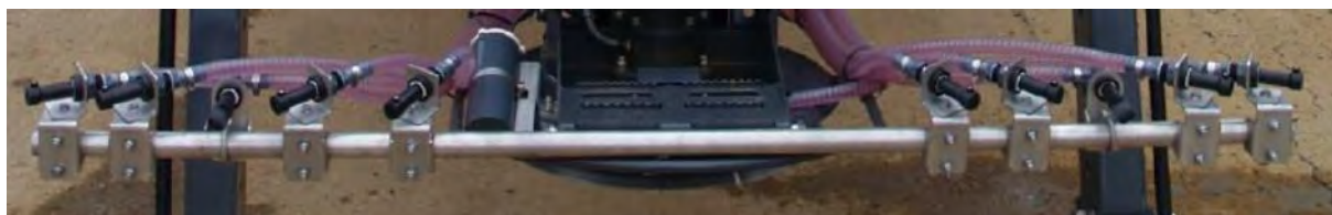
Figur 8-7 Spredning av saltløsning med tallerken eller dyser
