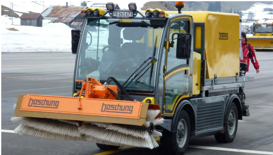
Figur 4-52 Eksempel på børsteutstyr for gang- sykkelareal (Foto: Dagfin Gryteselv, Statens vegvesen)
