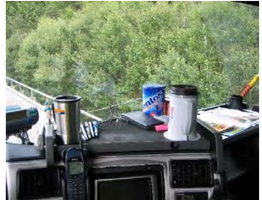
Gjenstander på ettermontert bord skaper blindsoner (de grønne «armene» i figuren til venstre).
