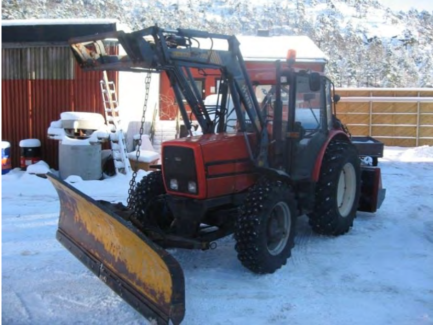
Figur 2-68 Lasteapparatet brukes til å heve og senke brøyteskjæret. Dette skaper ekstra blindsoner. (Foto: Jahn Ivar Systad)
