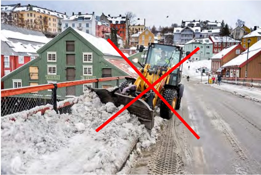
Figur 4-56 Eksempel på kjøretøy som er dårlig egnet til jobben som skal utføres (for tungt og bredt for brøyting på fortau) (Foto: Knut Opeide, Statens vegvesen)
