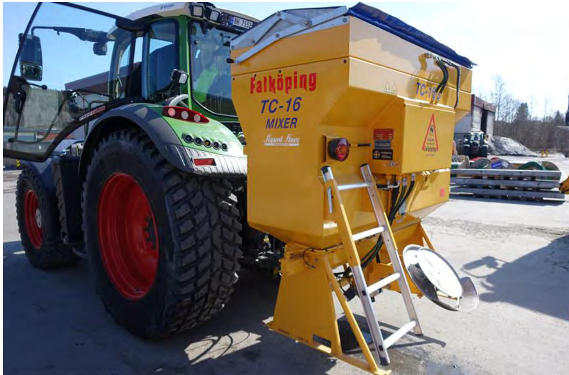
Figur 7-10 Lavtemperatur Fastsandsenhet for gang-sykkelarealer.
