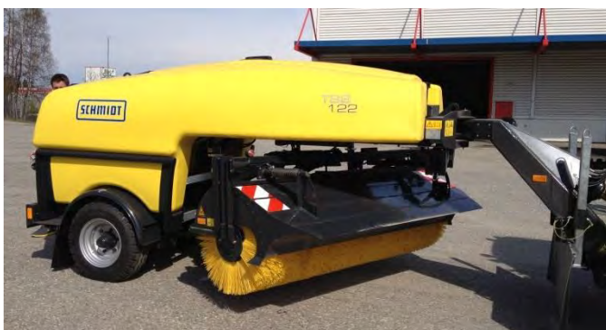
Figur 6-14 Roterende kost og løsningspreder for gang- og sykkelarealer. Trekket av en traktor. (Foto: Dagfin Gryteselv, Statens vegvesen)
