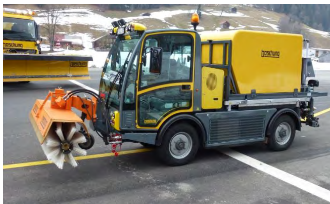
Figur 6-11 Eksempel på utstyr for gang- og sykkelarealer med frontmontert kost og dysespreder (Foto: Dagfin Gryteselv, Statens vegvesen)
