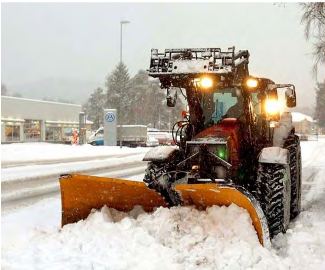
Figur 4-87 HMS under utførelse? Lysbruk, dekkutrustning, sikt m.m. (Foto: Tore Svareverud, Varden.no)
