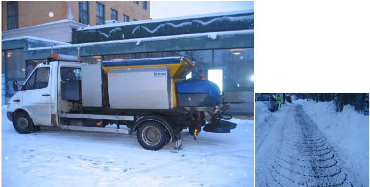
Figur 6-15 Kjøretøy for fastsandspredning på gang- og sykkelarealer som er benyttet i Umeå kommune (prototype) (Foto: Anna Niska, VTI Sverige)
