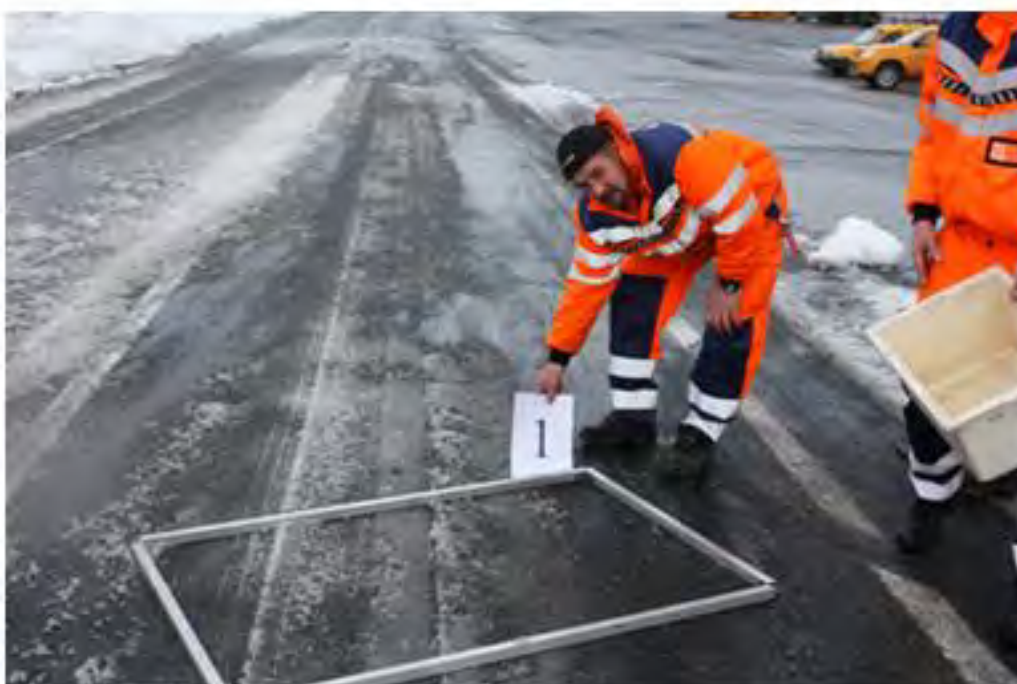
Figur 4-61 Mengde snø før og etter tiltak ved brøyting i 60 km/t. Mye snø/slaps er ikke fjernet. (Foto: Statens vegvesen)
