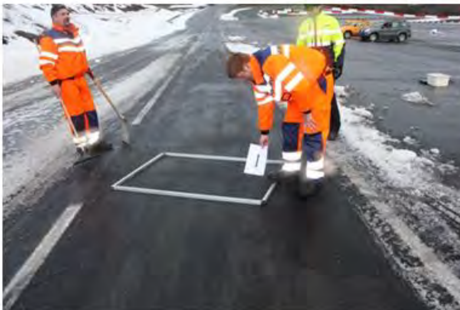
Figur 4-62 Mengde snø før og etter tiltak ved brøyting i 40 km/t. Det meste av snø/slaps er fjernet. (Foto: Statens vegvesen)
