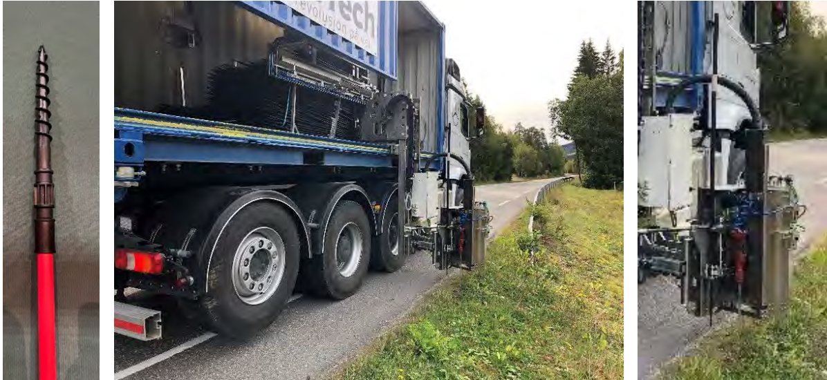
Figur 9-40 Skrubrøytestikk og utstyr for utsetting (Foto: RoadTech)
