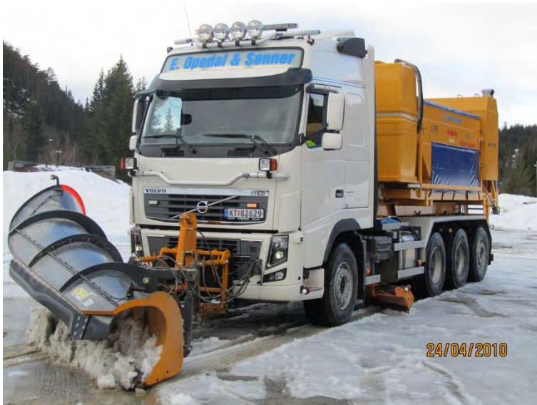
Figur 4-20 Fire-akslet lastebil utstyrt med diagonalplog, underliggende skjær og salt-/fastsandspreder (Foto: E. Opedal & Sønner)
