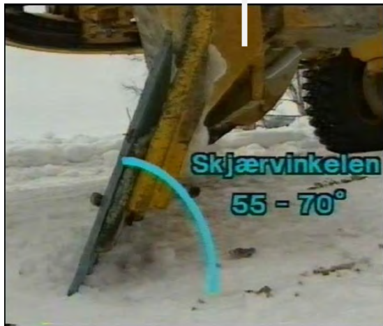
Figur 4-79 Riktig skjærvinkel mellom høvelskjær og underlag
