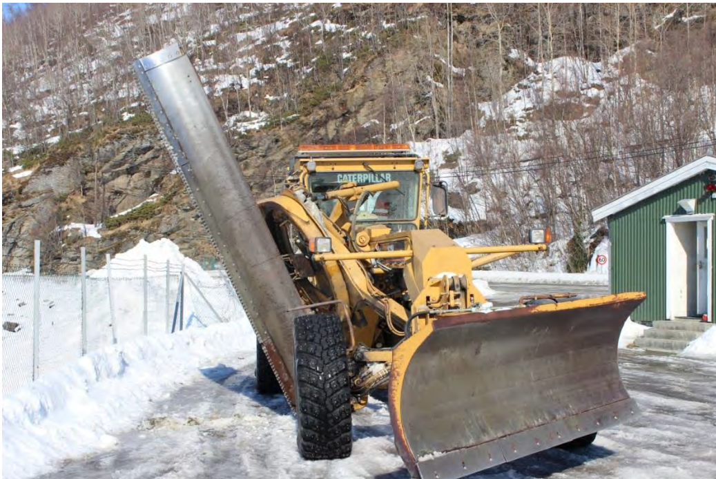
Figur 4.77 Høvel for nedtaking av snøkanter (Foto: Odd Dalmo, Statens vegvesen)
