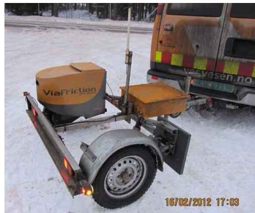
Figur 5-18 ViaFriction-friksjonsmåler, hengerversjon (Foto: Dagfin Gryteselv, Statens vegvesen)
