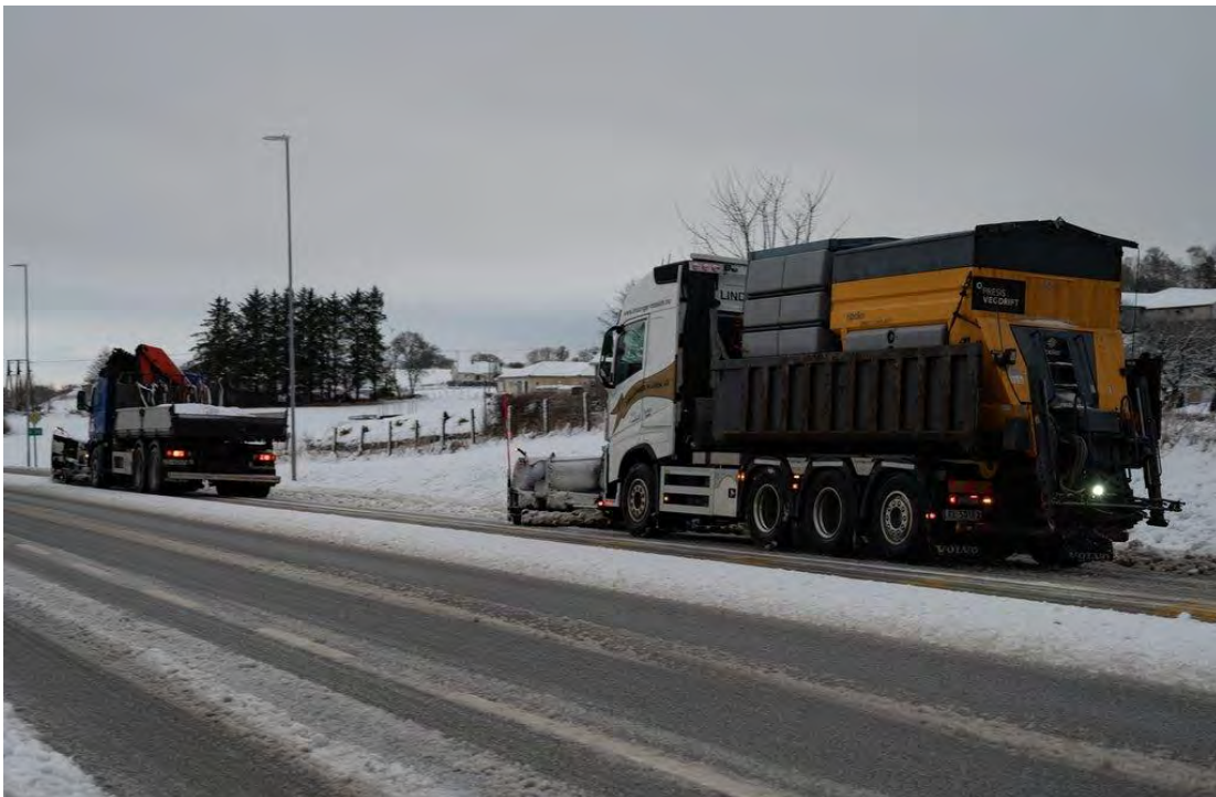
Figur 10-2 Brøyte-/strøbil med automatisk datafangst (Foto: Bård Asle Nordbø, Statens Vegvesen)
