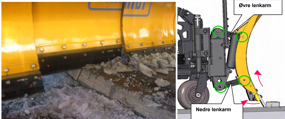
Figur 4-33 Bevegelige plogseksjoner på fortauskant (Kilde: Schmidt Norge AS)
