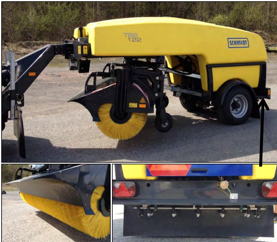
Figur 4-53 Eksempel på traktormontert etterhengende sweeper med saltløsnings-spreader (Foto: Dagfin Gryteselv, Statens vegvesen)
