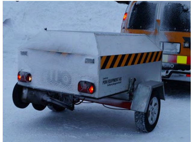
Figur 5-16 TWO-friksjonsmåler, hengerversjon (Foto: Bård Nonstad, Statens vegvesen)
