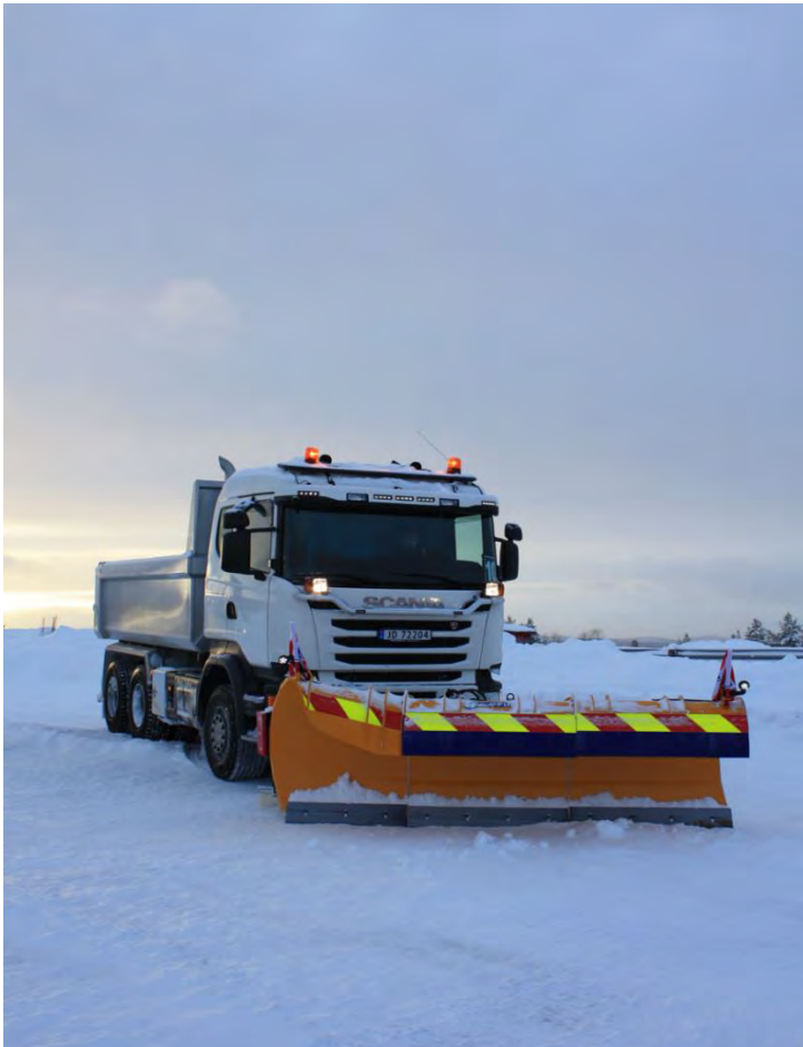
Figur 4-29 Kombinasjonsplog (Foto: Øveraasen)
