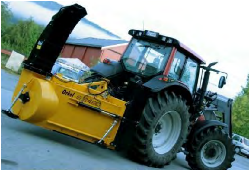
Figur 4-49 Bakmontert v-fres på traktor (Foto:Orkel AS)
