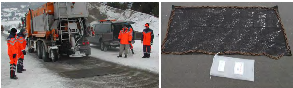
Figur 6-22 Kontroll av utstrødd mengde strømaterial med utlagte duker (Foto: Torgeir Vaa og Stein Hoseth)
