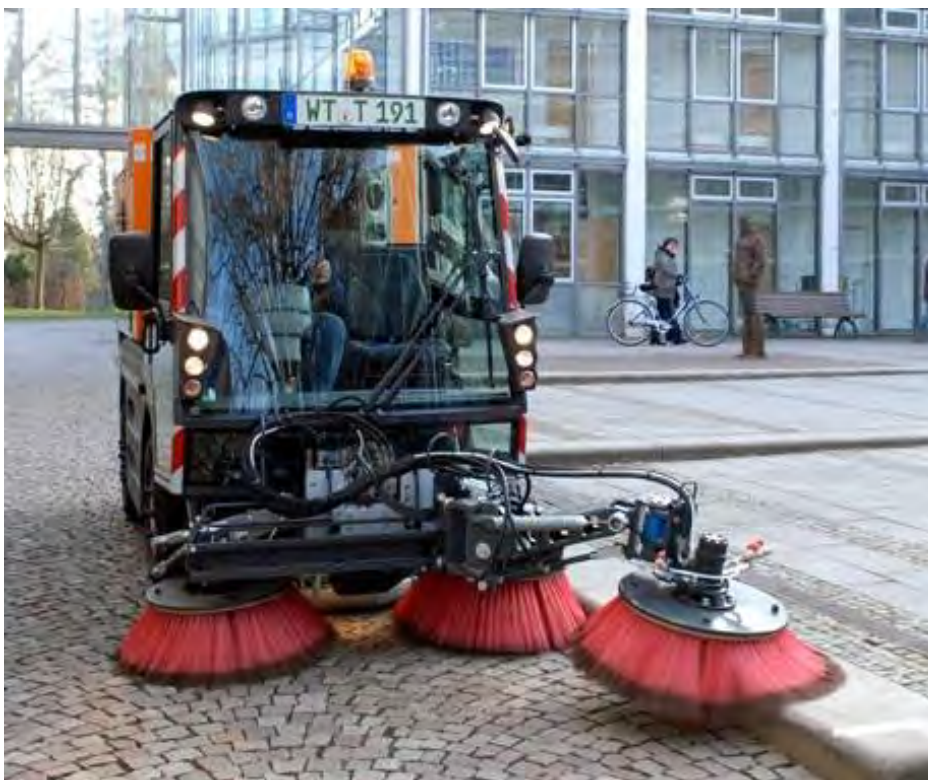
Figur 9-48 Utstyr for renhold av fortau, gang-/sykkelarealer og plasser. PM10-sertifisert (Kilde: www.Aebi-Schmidt.no )
