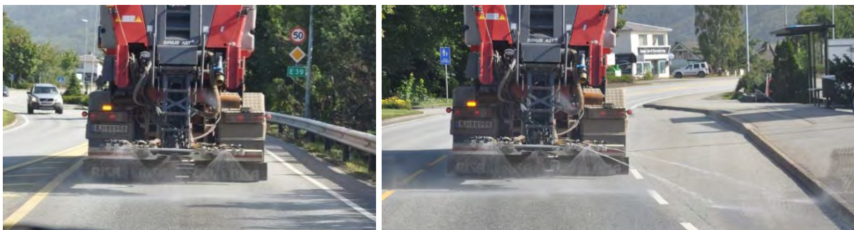
Figur 6-32 Varierende spredebredde styrt av GNSS-posisjon (Foto: Dagfin Gryteselv, Statens vegvesen)
