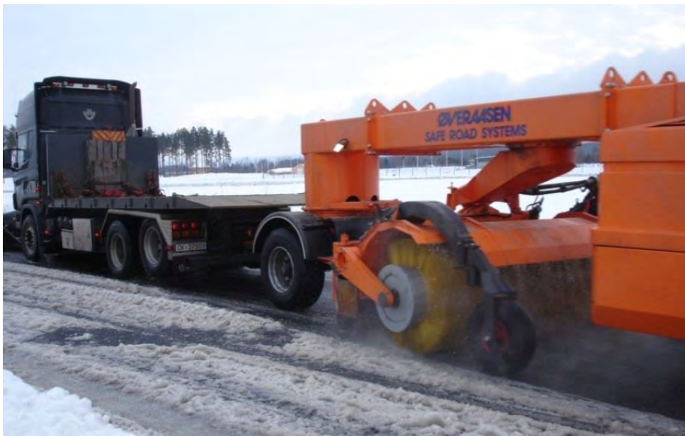
Figur 4-46 Etterhengende vegsweeper (motordrevet kost) (Kilde: Øveraasen)
