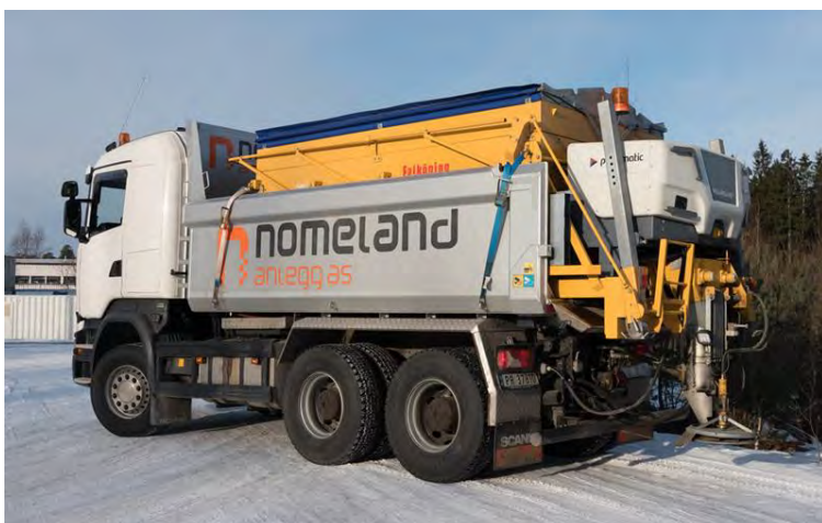
Figur 6-6 Varmsandspreder (Foto: Normeland Anlegg)
