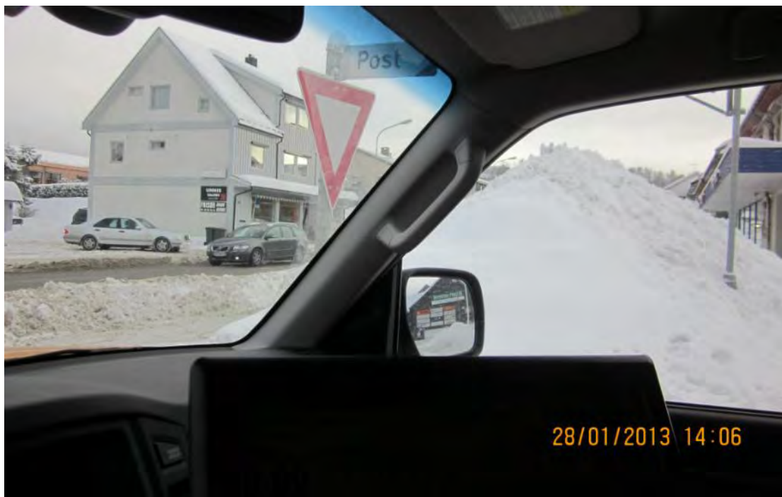
Figur 4-72 Sikt i kryss ikke godkjent! (Foto: Rudi Thomassen, NVE Anlegg)
