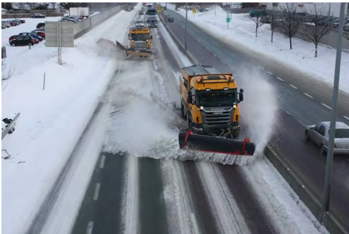
Figur 4-59 Eksempel på tandemkjøring (vær obs på snøsprut på motgående trafikk) (Foto: Statens vegvesen)
