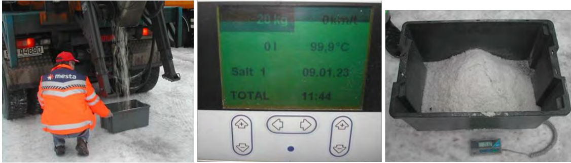
Figur 6-24 Kontroll/kalibrering av spredder med oppsamling og veiing
