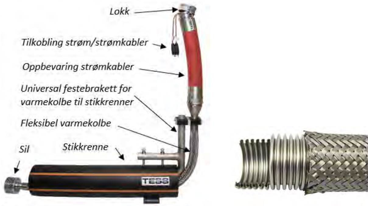
Figur 9-36 Varmekabler for bruk i stikkrenne, eksempel på fleksibel stålslange med beskyttelsesstrømpe (Foto: Tess)
