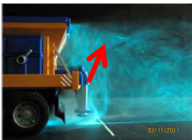
Figur 6-28 Vertikale luftstrømmer bak en lastebil i fart
