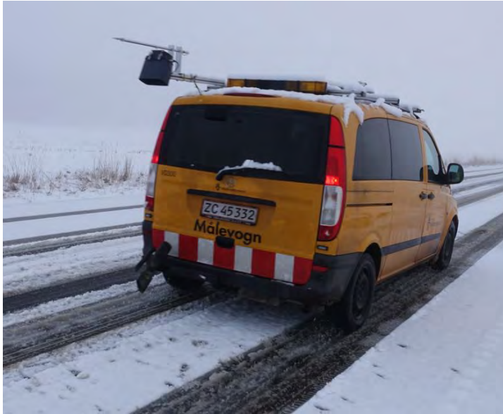
Figur 5-19 To ulike optiske sensorer montert på dansk målebil (Foto: Bård Nonstad, Statens vegvesen)
