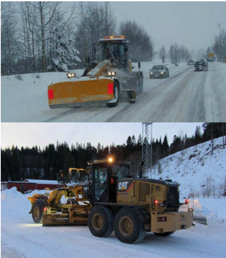
Figur 4-23 Veghøvel med isriverskjær og frontblad (Foto: Statens vegvesen)
