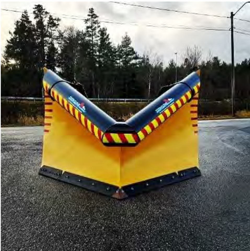
Figur 4-25 Spissplog (Foto: Eirik Almedal, Steinsland Mek. Verksted AS)
