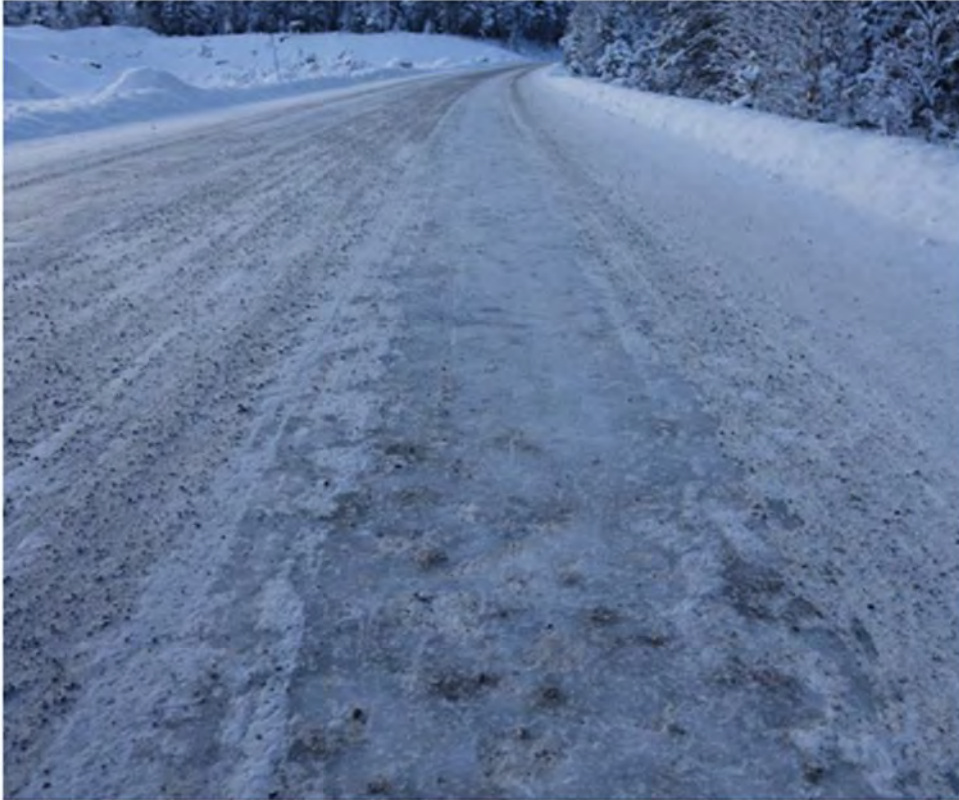
Figur 7-13 Varighet av tørrsandtiltak. Her har ca. 100 personbiler passert etter strøtiltaket. Det er mye sand som ligger mellom hjulsporene, men i hjulspor er det lite igjen. (Foto: Bård Nonstad, Statens vegvesen)
