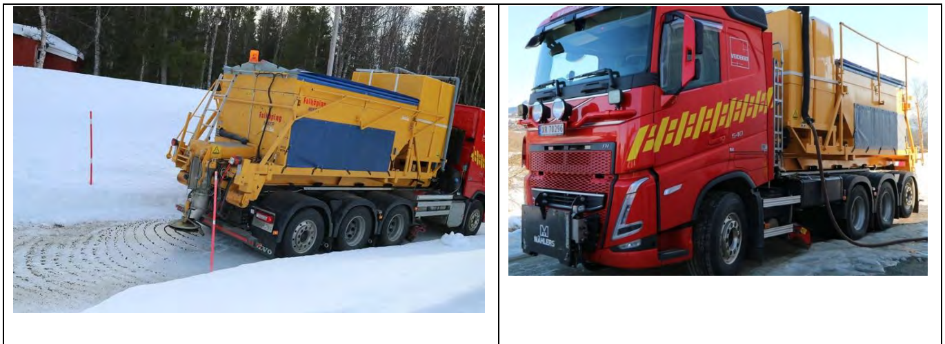
Figur 7-9 Lavtemperatur Fastsandsenhet under uttesting og påfylling av vann. (Foto: Veidekke)
