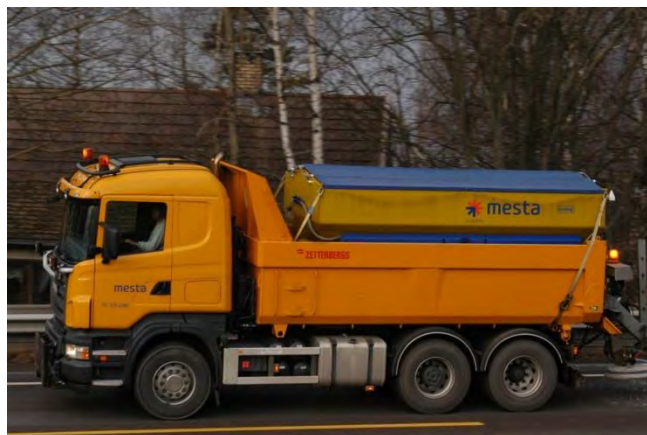
Figur 8-4 De-ising – Salting for å fjerne et is- eller snødekke (Foto: t.v. Torgeir Vaa, t.h. Håkon Aurlien)
