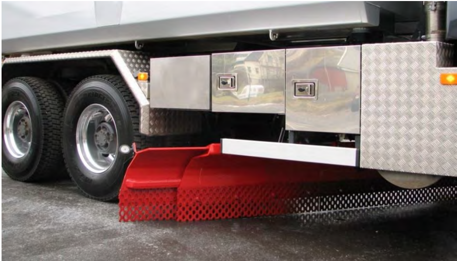
Figur 4-37 Underliggende skjær (Foto:Tellefsdal AS)
