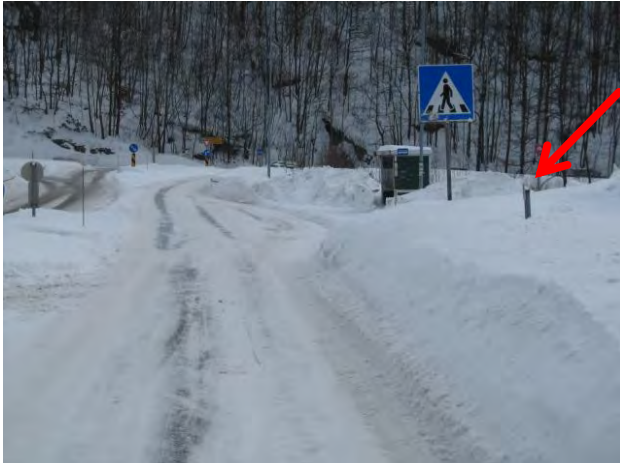
Figur 2-24 Manglende siktrydding mot kryssingspunkt på grunn av koblingsskap i siktsonen (Foto: Arild Nærum)
