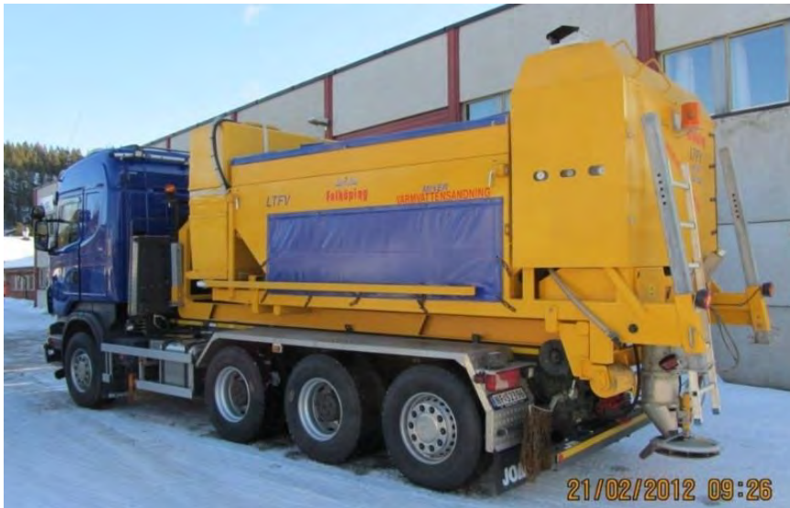
Figur 6-4 Fastsandspreder kan også brukes som saltspreder for befukning med varmt eller kaldt vann (Foto: Dagfin Gryteselv)
