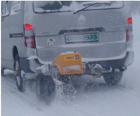
Figur 5-15 TWO-friksjonsmåler, rammemontert (Foto: Bård Nonstad, Statens vegvesen)
