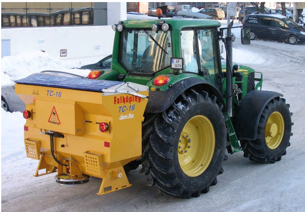
Figur 6-16 Bakmontert strøpparat for traktor (Foto: Per Ingar Haug)
