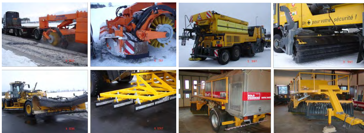
Figur 4-64 Spesialutstyr testet på Vålerbanen. RSS 200, Jet Broom, Slapsegrend montert på høvel og «Slapsekaren»
