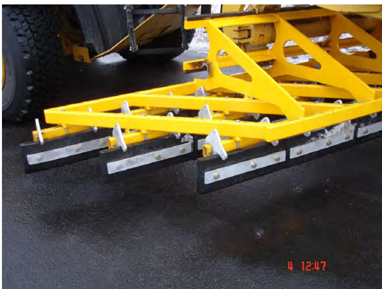
Figur 4-48 Slapsegrind montert på høvel (Foto: Torgeir Vaa)
