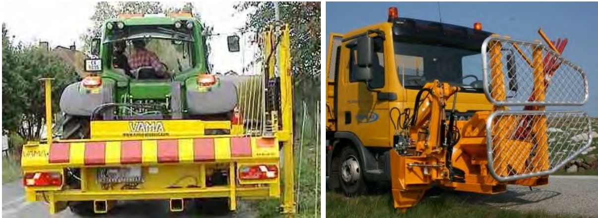
Figur 9-39 Utstyr for oppsetting av brøytestikk montert på traktor og lastebil (Foto: t.v. Torp Maskin AS, t.h. Risa AS)
