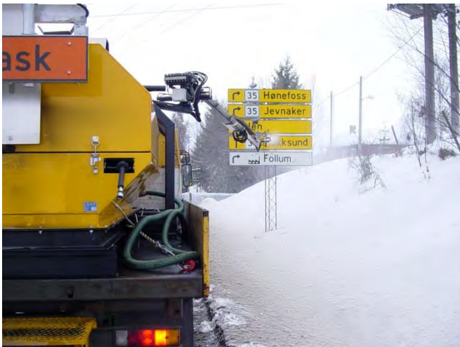
Figur 9-38 Skilt- og kantstolpevask
