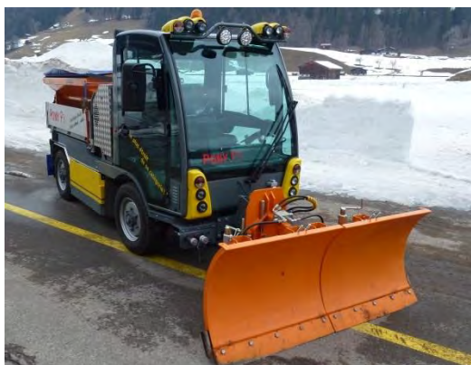
Figur 6-10 Eksempel på utstyr for gang- og sykkelarealer med tallerken-spreder (sand/salt) og frontplog (Foto: Dagfin Gryteselv, Statens vegvesen)
