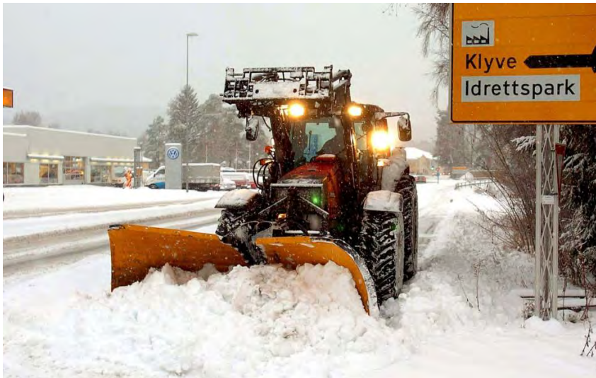
Figur 2-80 Eksempel på høyt monterte arbeidslys (Foto: Tore Svarverud, www.Varden.no )
