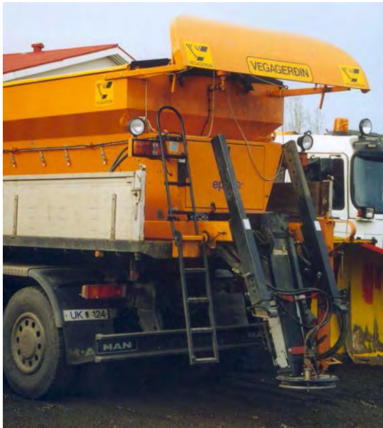
Figur 6-29 En toppvinge (spoiler) vil kunne redusere luftstrømmen opp bak bilen
