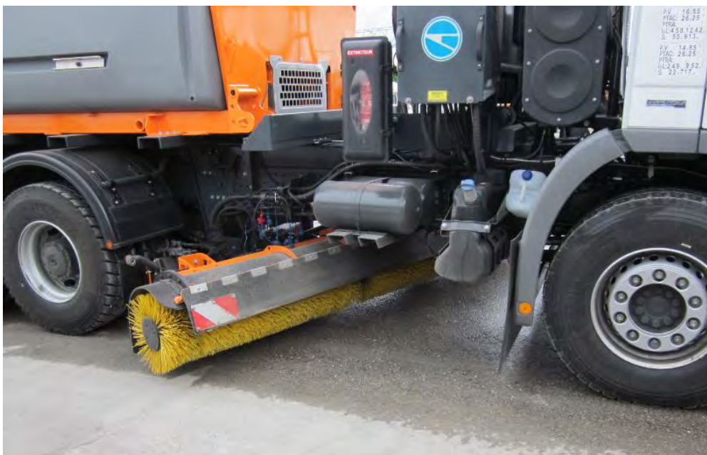
Figur 4-47 Underliggende kost (Gilletta) (Foto: Peder Tangen, Statens vegvesen)
