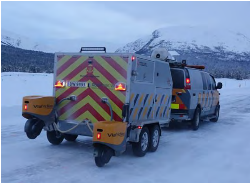
Figur 5-13 Friksjonsmåling på vinterføre med to spors Roar-måler (Foto: Bård Nonstad, Statens vegvesen)
