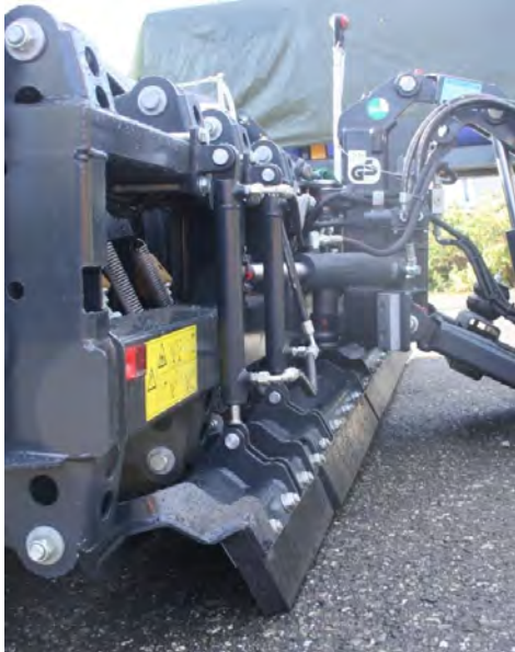
Figur 4-45 Gummiskjær/lameller montert bak på plog (Foto: Schmidt Norge AS)
