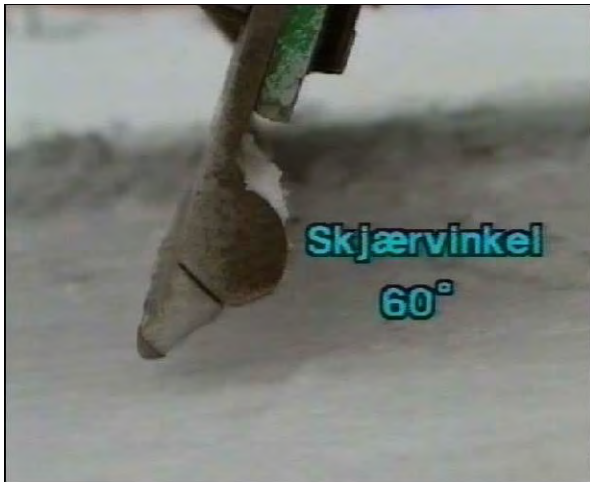
Figur 4-80 Riktig skjærvinkel med hardmetallstift (System 2000)
