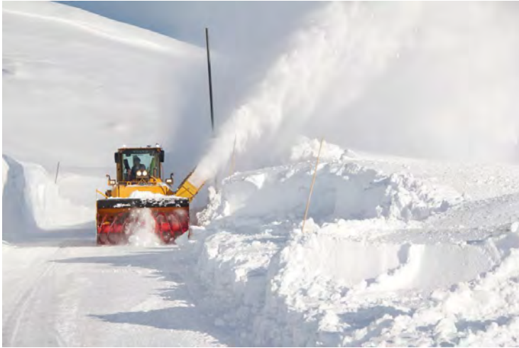
Figur 4-96 Rydding av brøytekanter, rv. 13 Vikafjellet (Foto: Sogn Avis)
