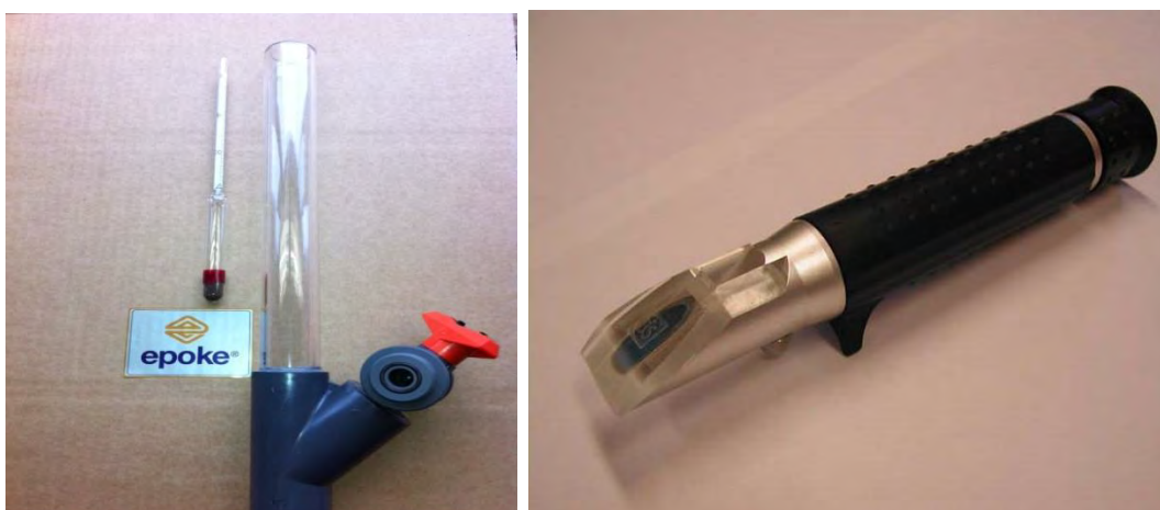
Figur 8-6 Eksempel på utstyr for måling av saltkonsentrasjon i løsning (Foto: Statens vegvesen)
