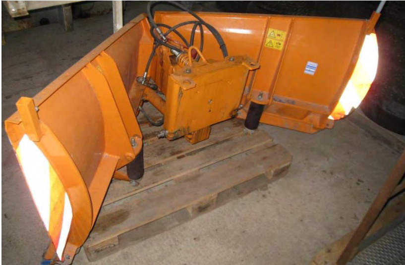
Figur 4-54 Eksempel på plog egnet for arbeid på gang- og sykkelarealer
