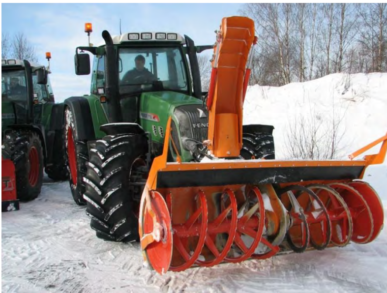
Figur 4-83 Frontmontert snøfres på traktor (Foto: Tellefsdal)
