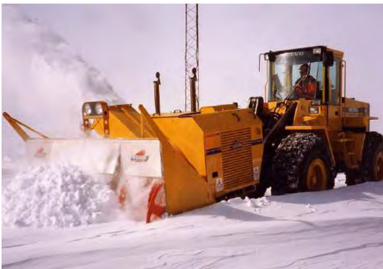
Figur 4-85 Unit-fres tilkoblet hjullaster (Foto: Øveraasen)
