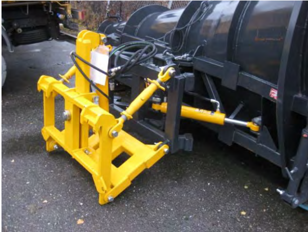
Figur 4-28 Diagonalplog med hydraulisk skråstilling (Foto: GMI)
