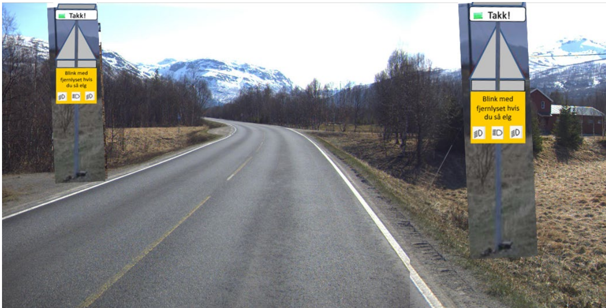
Figur 16 Konseptillustrasjon av del 2 systemet, utstyret er montert på baksiden av skiltstolpen som del 1 utstyret er satt på. Tekst på skiltet: «Blink med fjernlyset hvis du så elg» Illustrasjon Henrik Wildenschild, Statens vegvesen
