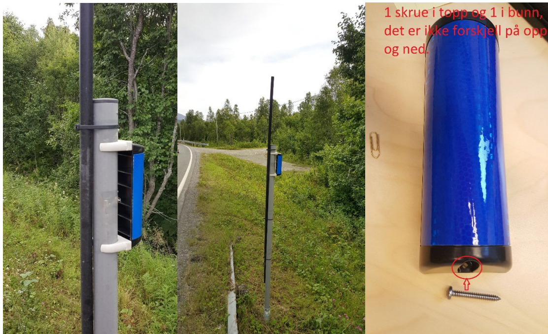
Figur 8 Bilder av de blå refleksene som ble brukt i forsøket på de tre teststrekninger. Foto Henrik Wildenschild, Statens vegvesen.
