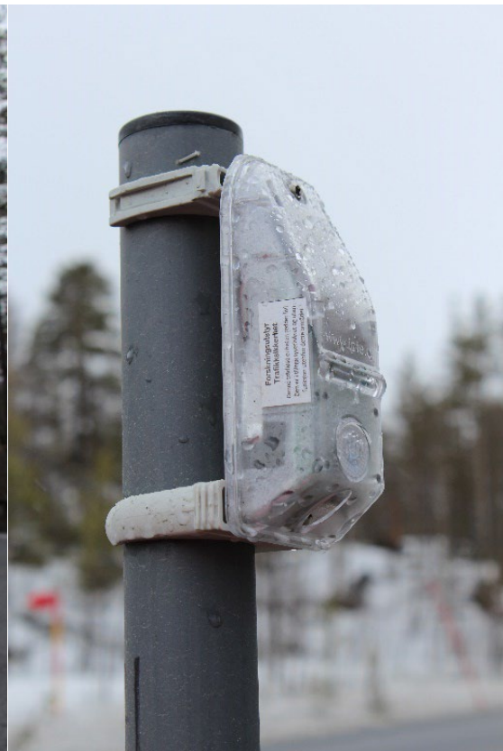
Figur 2 Foto og illustrasjon av Viltskremmer (Deer Deter DD450). Foto er tatt på de norske teststrekninger av Henrik Wildenschild, Statens vegvesen. Illustrasjon fra produsent IPTE.
