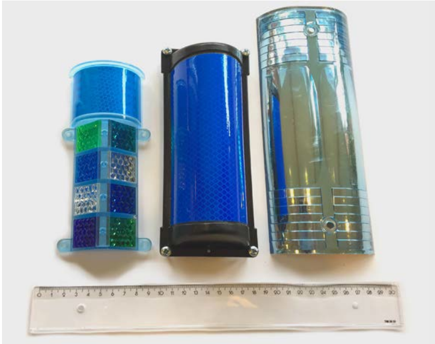
Figur 12 Bilde av de tre typer reflekser som ble testet ut i det svenske forsøket, refleksen i midten er samme type som ble montert i Norge. (Trafikverket, 2017)
