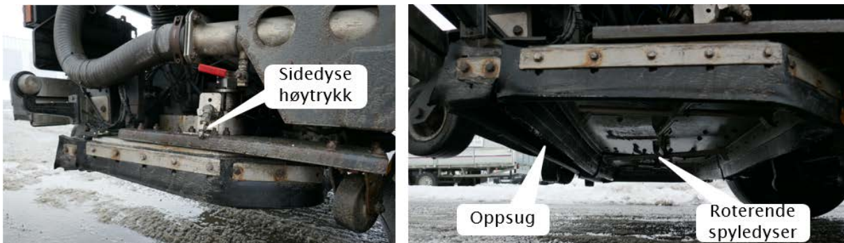
Figur 30: Baksystem/rotorclean, bilde tatt på bilens høyre side (Foto: Brynhild Snilsberg)
