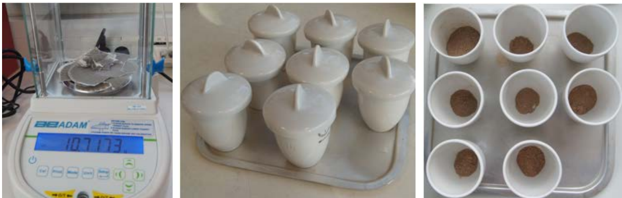
Figur 41: Veing og gløding av filterpapir (Foto: Inga-Loise Sætermo Veivåg)
