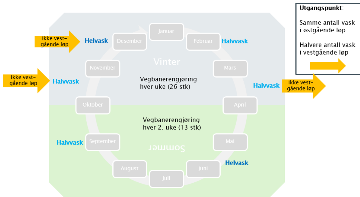
Figur 14: Renholdsfrekvens i prosjektperioden i begge løp i Strindheimtunnelen. De gule pilene markerer tidspunkt hvor det ble gjennomført hel- eller halvvaske i østgående løp, men ikke i vestgående løp.
