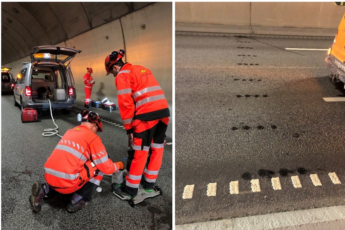
Figur 15: Prøvetaking med WDS (Foto: Brynhild Snilsberg)
