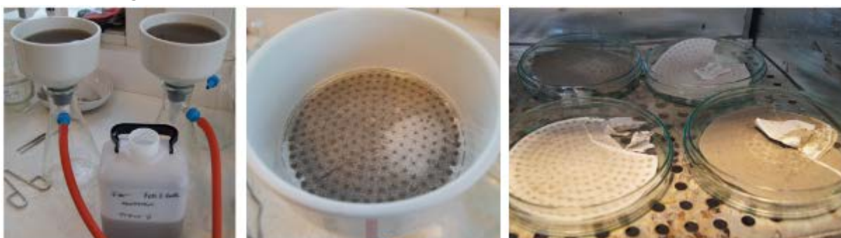
Figur 40: Filtrering og tørking av filterpapir (Foto: Inga-Loise Sætermo Veivåg)
