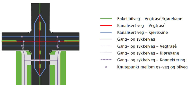
Figur 32: Nivådeling av gs-veg mot kjøreveg.
