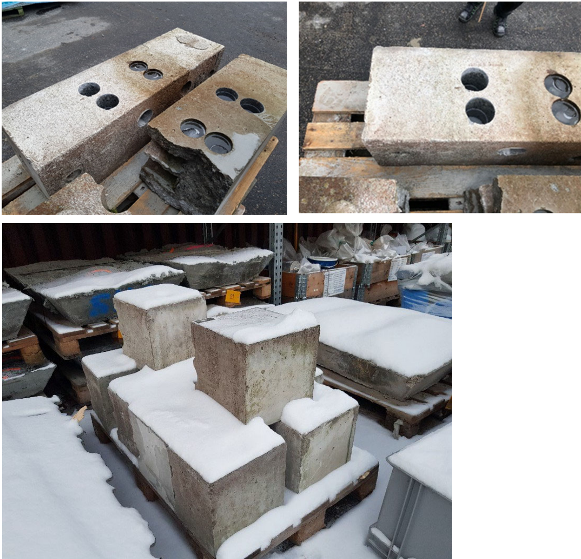
Figur 33 – Store feltprøvestykker etter kjerneuttak ved 8 år og etter saging (nederst) før de ble satt tilbake i feltstasjonen
