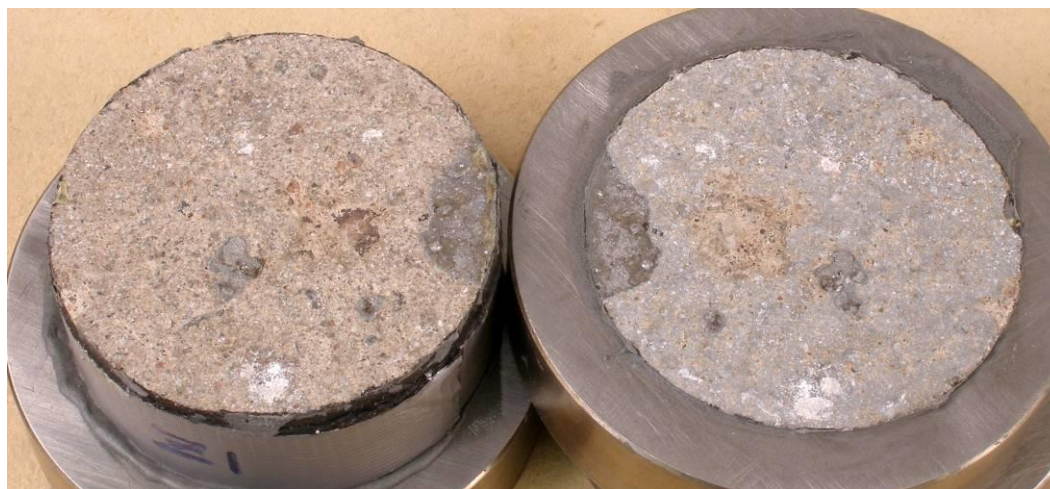
Figur 23B. Brottyta, vidhäftningsprov Z1
