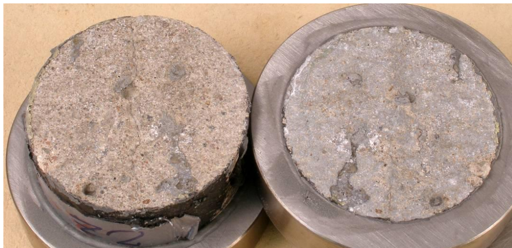
Figur 24B. Brottyta, vidhäftningsprov Z2
