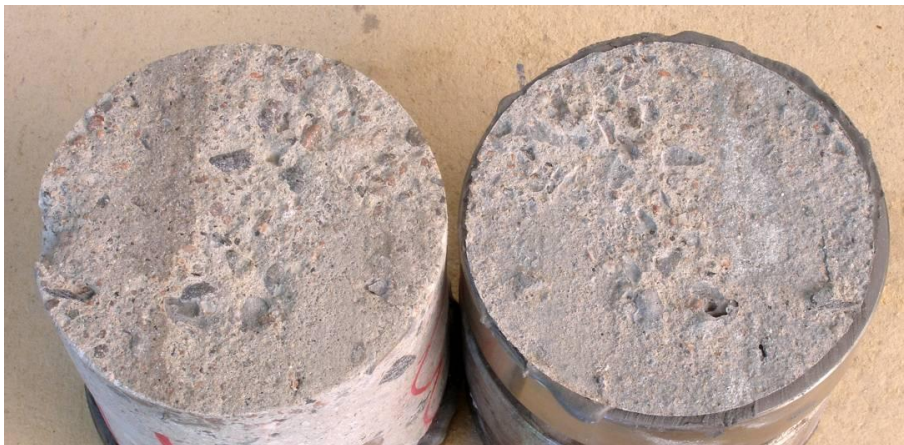
Figur 37B. Vidhäftningsprov 1B i atmosfären.
