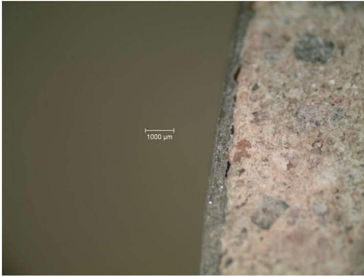
Figur 19B. Tvärsnitt av zinksikt och betongkärna. Zinkens tjocklek varierar mellan 300 och 700 μm. Ingen transport av zinkjoner in i betongen har konstaterats.
