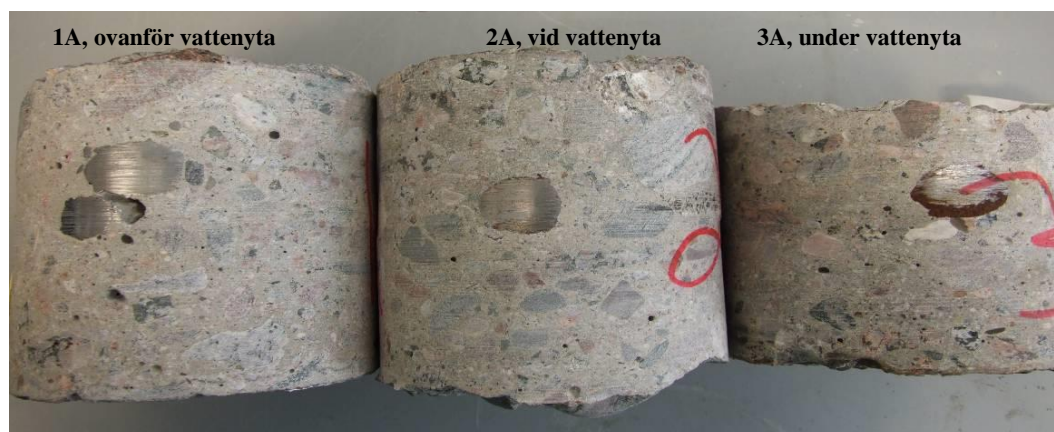
Figur 29B. Utseendet hos armeringen i uttagna betongkärnor
