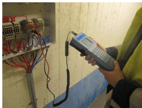
Figur 64B. Kontrollmätning av skyddsförmågan med extern referenselektrod, Ag/AgCl. (t v) och mätning av de ingjutna anodernas strömavgivning med nollresistans-ampremeter (t h)
