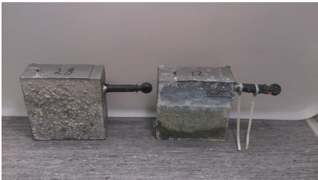
Figur 60B. Provblock 12 med tillhörande referens 28. Dessa provkroppar har varit halvt nedsänkta i vatten under provningstiden.
