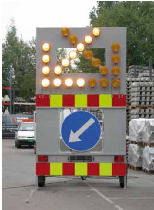
Figur 28 Eksempel på blinkende lyspil på varselpanel
