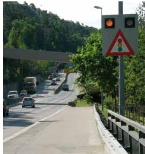
Figur 26 Eksempel på gult blinksignal sammen med trafikkskilt
