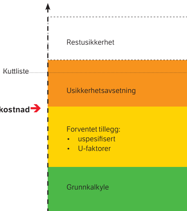
Figur 2-2: Oppbygning av et kostnadsoverslag etter Anslagsmetoden
