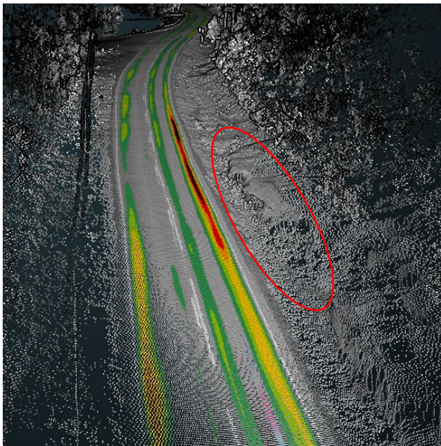
Figur 49: Visualisering av sammenheng mellom bergskjæring og økt spordybde (mørkere farge = dypere spor).
