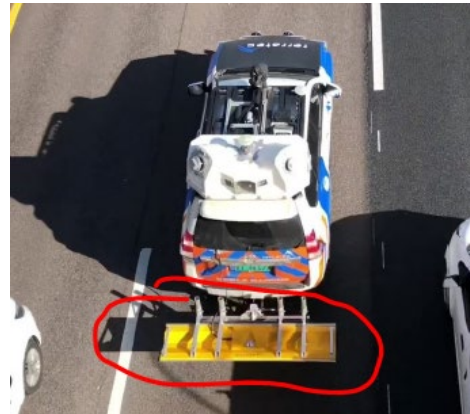
Figur 4: 3D-radar antenne med frekvensbånd på 200-3000 MHz
