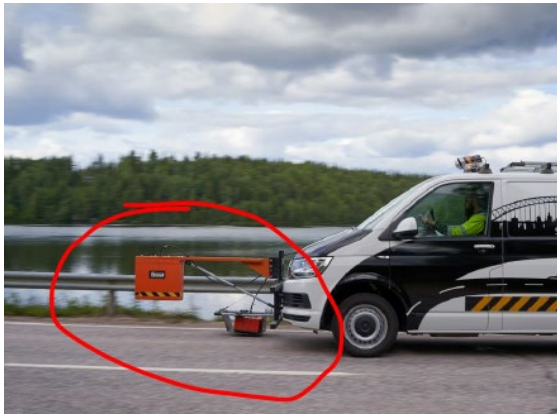
Figur 3: 2 GHz luftkoblet hornantenne og en 400 MHz jordkoblet antenne
