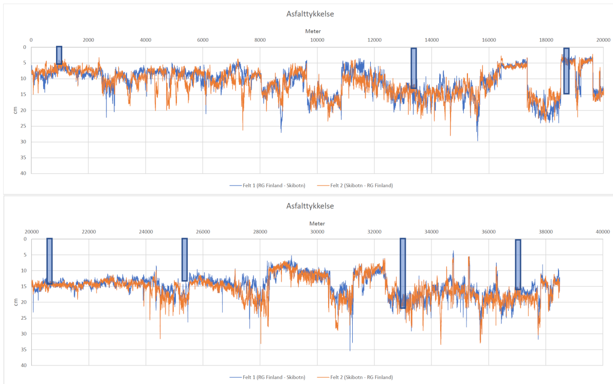
Figur 16: Asfalttykkelser kartlagt med georadar. Asfalttykkelser fra boreriger vist som søylar.
