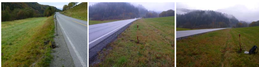
Figur 2: Illustrasjon av prøve tatt i vegskulder (venstre), i veggrøft (midten) og ca. 5m fra veg (høyre).
