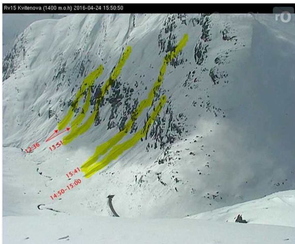
Figur 14: Resultat etter bruk av bildeserier tatt fra Kvitenoa i faste utsnitt og med faste mellomrom (10 minutter). Dette avslører fire (gulmarkerte) skred 24. april 2016 (se regobs 95521 ). Skred kl. 12:36 og 13:51 ble også bekreftet av infralydanlegget, mens skred ca. 14:55 og 15:41 lå delvis i skyggen for datidens plassering av infralydsensorer og er ikke bekreftet.
