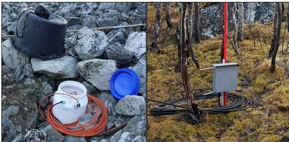
Figur 5: Venstre: plastbokser som rommer infralydsensorer. Murerbøtten lå over den hvite boksen for å beskytte denne. Disse ble brukt fram til 2018. Høyre: Nye sensorbokser produsert av Wyssen i Sveits fra 2018 (foto: Wyssen Norge AS).
