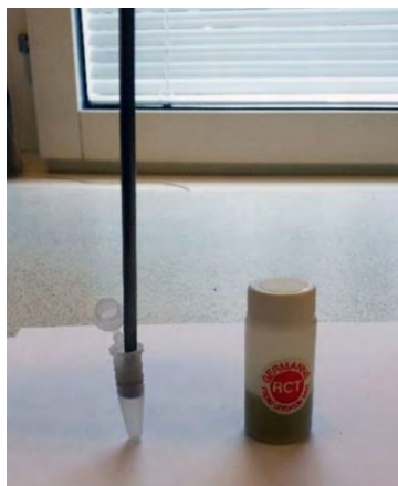
Figur 3.4.4-4: Oppstamping av støv til indikatorlinje og plastflaske med opplutningsvæske
