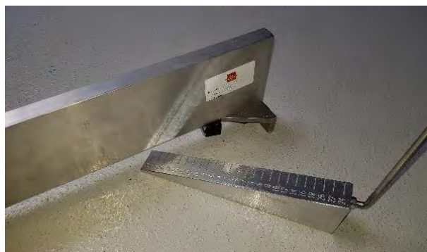
Figur 4.2.1-2: Rettholt med 30 mm knaster, og tosidig skalert målekile (foto: Johnny Stenshagen)
