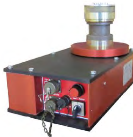
Figur 1.2.2-7: Eksempel på vingeborinstrument med digital styring og registrering
