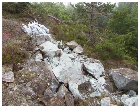
Figur 1.4.3-1: Prøvetaking av berg for undersøking av steinmaterialkvalitet. Det er viktig å unngå svake delprøver med overflatenær forvitring.
