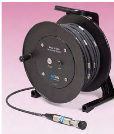
Figur 1.2.4-6: Eksempel på målekabel med trommel
