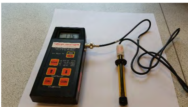
Figur 3.4.4-3: Kloridselektiv elektrode tilkoblet elektrometer (millivoltmeter)
