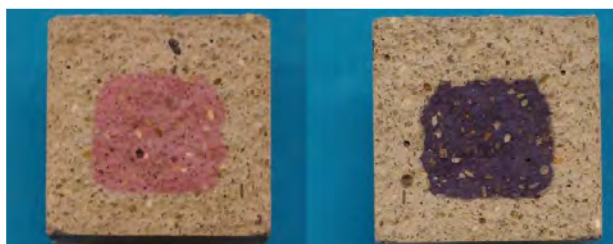
Figur 3.4.3-1: Mørtelprismer splittet og påført fenolftalein (til venstre) og tymolftalein (til høyre)
