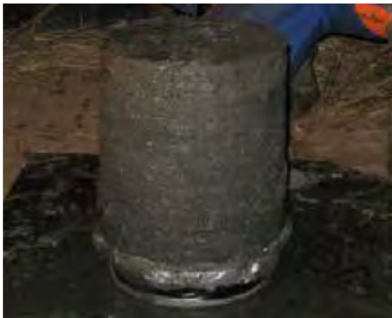
Figur 1.3.2-7: Prøve tatt med Sherbrooke prøvetaker
