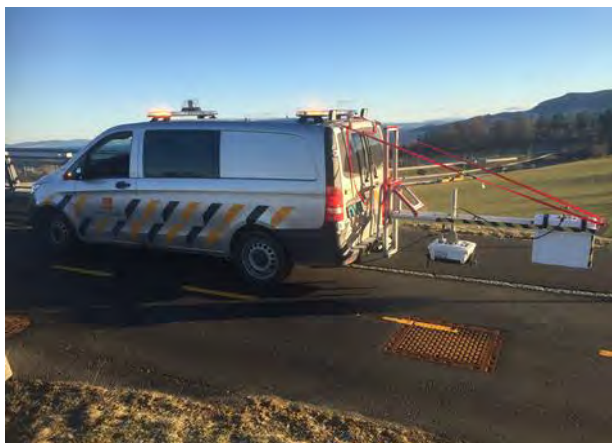
Figur 4.2.8-3: Georadar montert på målebilen
