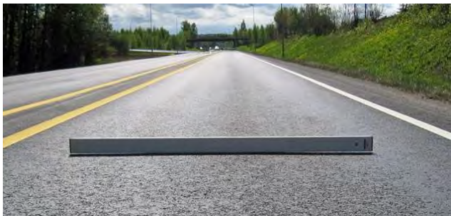
Figur 4.2.1–4: Måling av jevnhet i tverrprofilen. Rettholt uten knaster (foto: Torleif Haugdegård)
