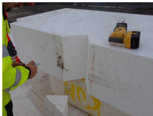
Figur 1.5.2-4: Eksempel på utskåret trekantprisme fra blokkside
