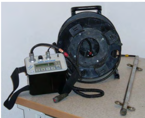
Figur 1.2.4-11: Eksempel på utstyr med kabeltilkobling til avlesningsinstrumentet (benyttes for tiden av Statens vegvesen)
