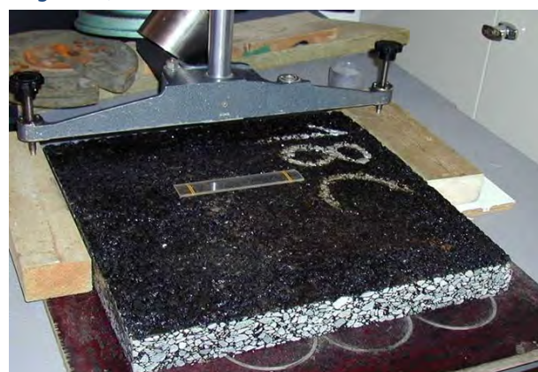
Figur 4.2.4-2: Bruk av pendelapparat i lab på prøvestykke av asfalt. Mal med avstandsmerker er vist på bildet (foto: Bård Nonstad, Statens vegvesen).
