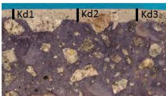
Figur 3.4.3-3: Synlig karboniseringsfront etter behandling med indikatorvæske (her tymolftalein). Karboniseringsdybden måles her i 3 punkter, som legges slik at man unngår store tilslagskorn.
