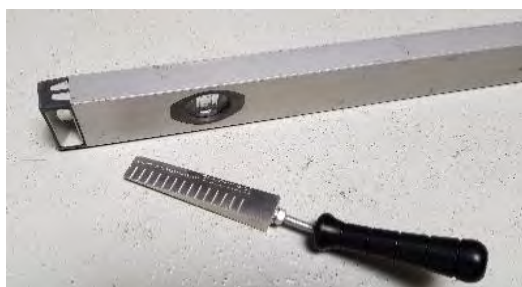
Figur 4.2.1-1: Rettholt uten knaster med ensidig skalert målekile (foto: Johnny Stenshagen)
