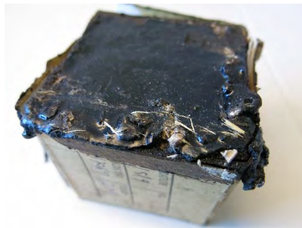
Figur 2.3.5-5: Forurenset prøve med smeltet plastfolie (Foto: Statens vegvesen)
