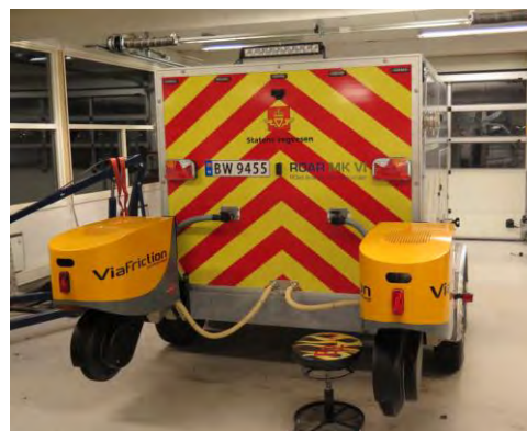
Figur 4.2.6-2: Roar 6 med to målehoder. Foto: Rune Pettersen, Viatech
