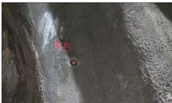
Figur 1.4.10-3: Prisme montert og beskyttet inne i et kort grovhull på lesiden (ift. stuff) av en sprøytebetongbue. Råtunnelen, E39 Bergen-Os
