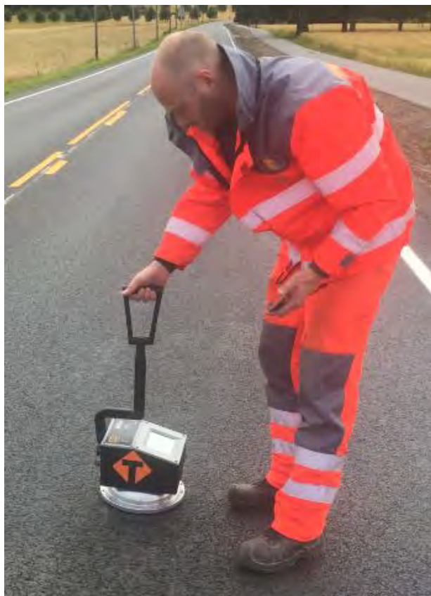
Figur 2.3.4-2: Måling av dekkets densitet med induksjonsmåler
