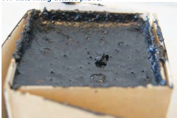
Figur 2.3.5-4: For lite prøve i esken – prøven krymper når den avkjøles. Må derfor fylles med 1–2 mm overhøyde (Foto: Statens vegvesen).
