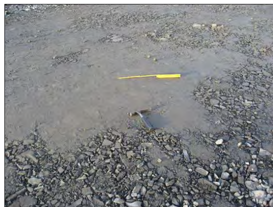
Figur 2.2.1-2: Finstoffanrikning i et utlagt materiale
