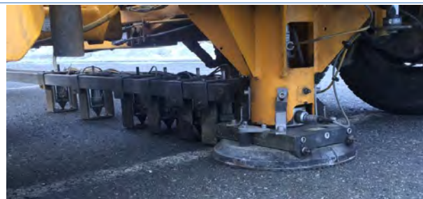
Figur 4.1.1–4: Belastningsplate og geofoner (foto: Haris Bricic)
