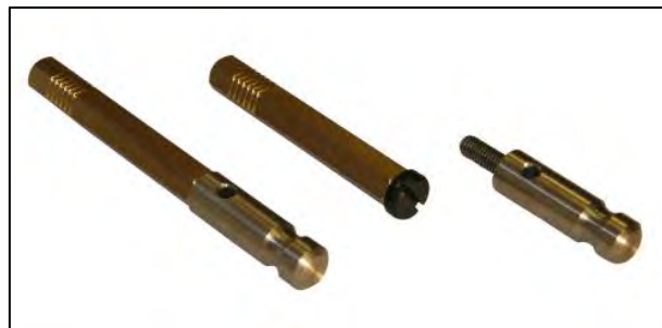
Figur 1.2.9–1: Eksempel på målebolt i messing. Boltene i midten plasseres helt inne i hullet slik at den er lite synlig og samtidig beskyttet mot skade. Høyre forlengelse skrues på ved måling.
