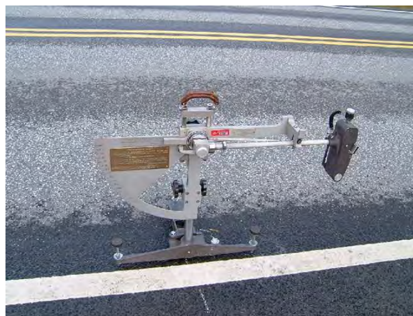
Figur 4.2.4-1: Pendelapparat ferdig oppstilt for måling på vegmerking (foto: Bård Nonstad, Statens vegvesen)
