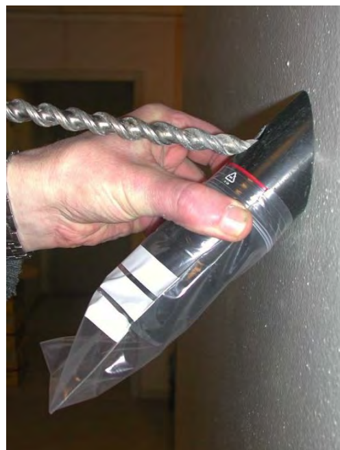
Figur 3.1.4-1: Eksempel på oppsamlingsutstyr ved utboring av støv fra vertikal flate
