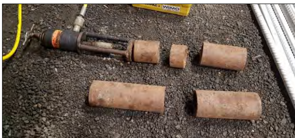
Figur 1.4.12-2: Solide distanserør i ulike lengder (foto: Wimo)
