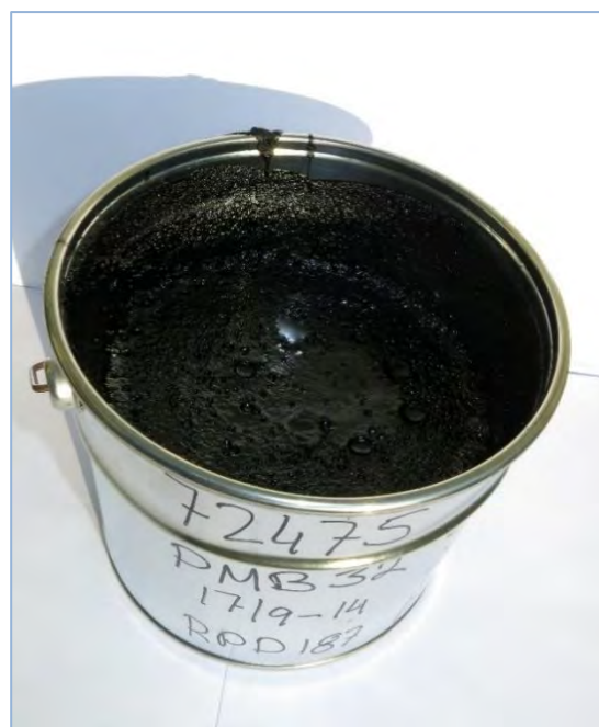
Figur 2.3.5–1: Prøveuttak i spann med lokk
