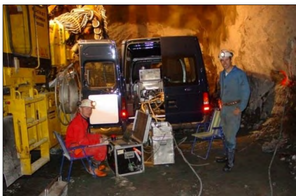
Figur 1.2.7-1: Spenningsmålinger Nye Tyn (Hydro)
