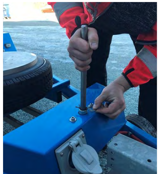
Figur 4.1.1-2: Sikringsbolt i transportmodus (foto: Bjørn Hoven)
