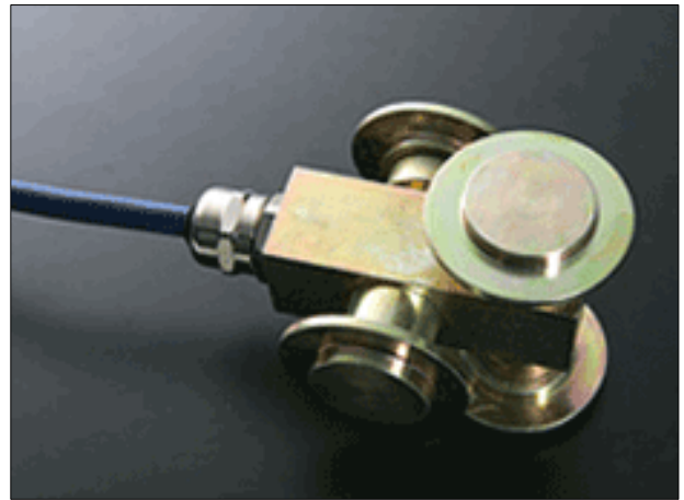
Figur 1.4.11–19: Eksempler på kryssmontert tøyingsmåler for sprøytebetong (Geogage)
