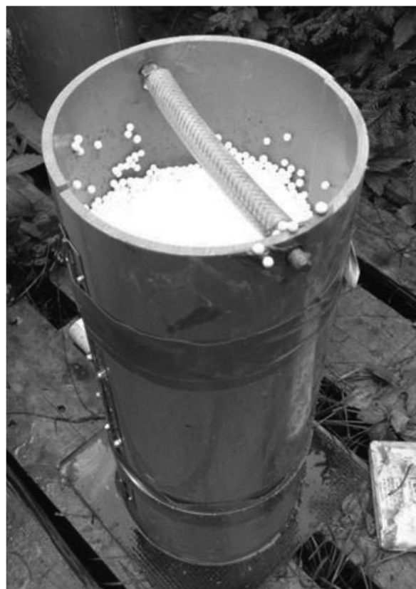
Figur 1.3.2-12: Transportrør fylt med poreplastkuler
