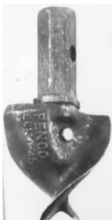
Figur 1.3.4-2: Prinsip og spisser for naverboring (fingerborespiss og fiskehalespiss)
