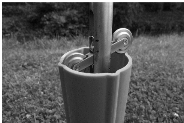
Figur 1.2.4-2: Eksempel på plastkanal med spor
