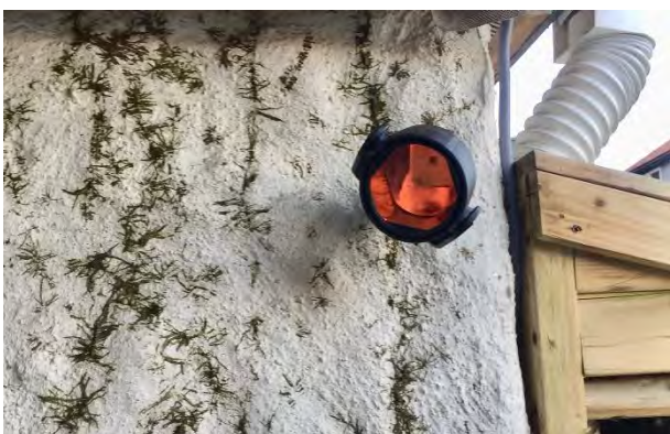
Figur 1.2.9-2: Øverst en målebolt med forlengelse på et hushjørne, nederst er et prisme klargjort for kontrollmåling (foto: Rune Samnøy)
