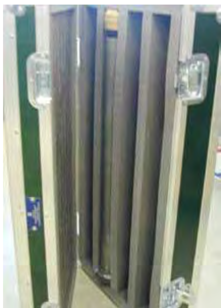
Figur 1.3.1–4 Transportkasse for skånsom frakt av prøver
