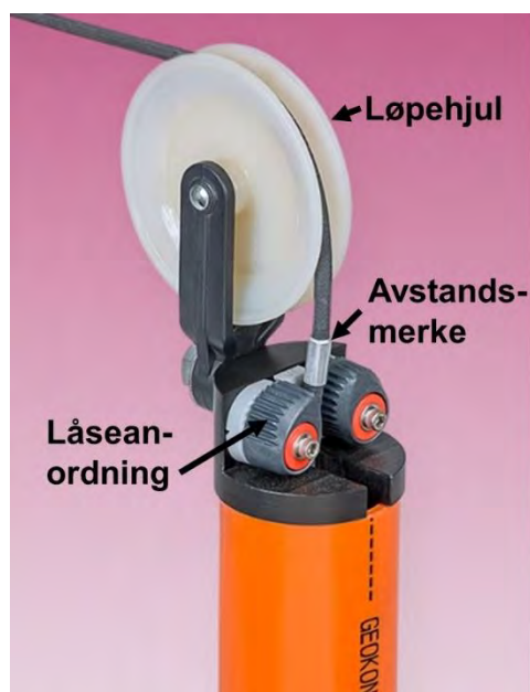
Figur 1.2.4-7: Eksempel på styrehjul og låseanordning
