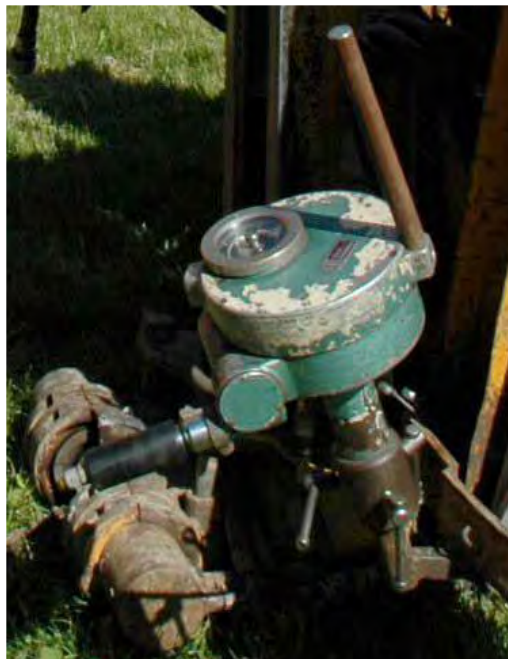
Figur 1.2.2-6 Vingeborinstrument med elektrisk motor for påføring av torsjonsmoment.
