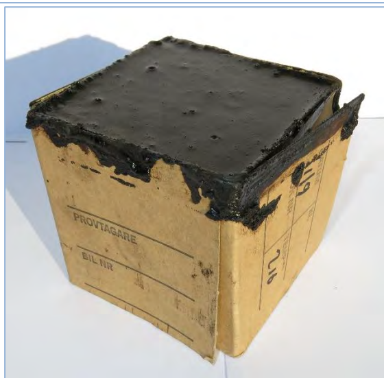
Figur 2.3.5–2: Prøveuttak av kloss i kartongeske (Foto: Statens vegvesen)
