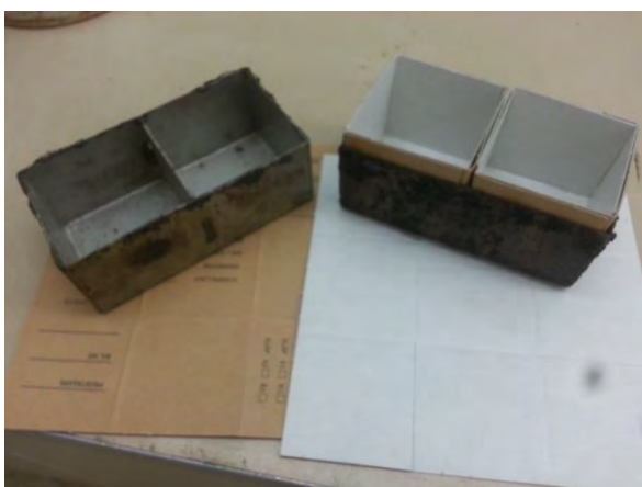
Figur 2.3.5–3: Eksempel på metallform for fylling av kartongesker (Foto: Spesialdekker, DABgroup)
