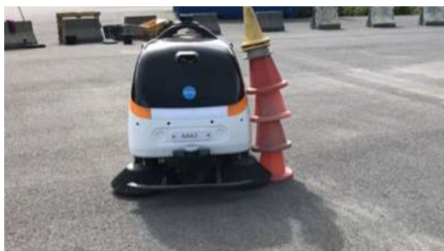
Figur 23: Test med kjegler som simulerer en person (Foto: I. Roche Cerasi).
