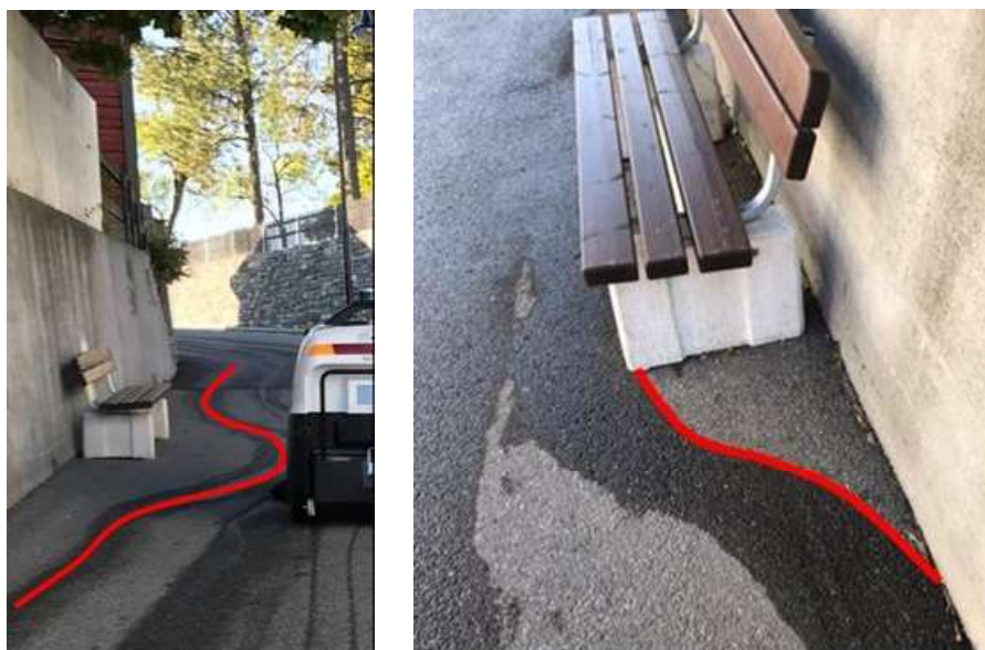
Figur 56: Kostning rundt benker med Spring S100N (Bildet til venstre) og bemannede gatefeiemaskin (Bildet til høyre) (Foto: I. Roche Cerasi).
