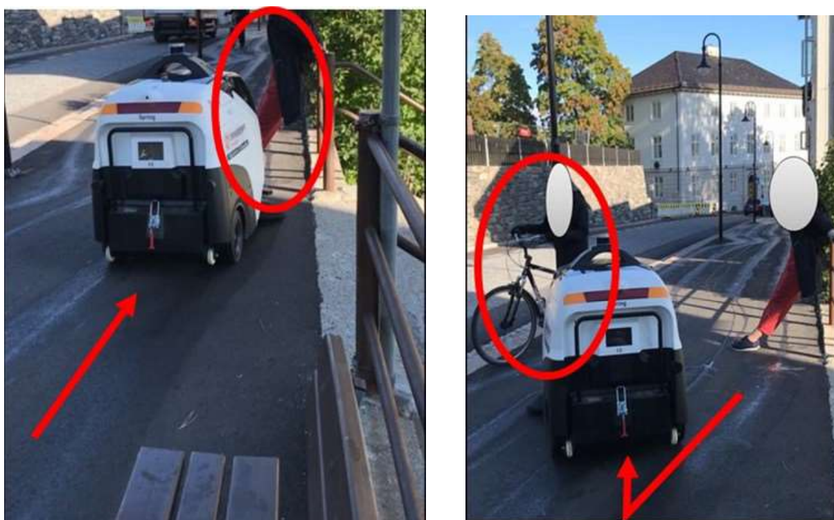
Figur 41: Maskinen stoppet pga. hindringer, rygget og kjørte forbi (Foto: I. Roche Cerasi).
