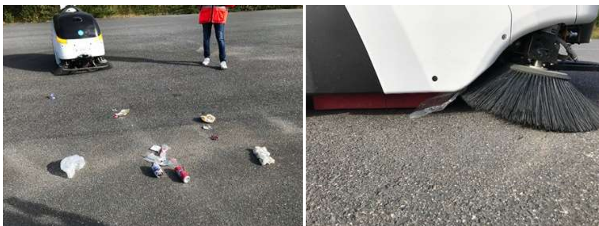
Figur 19: Sjøppel som ikke ble tatt opp av maskinen og plast som satt fast under maskinen (Foto: I. Roche Cerasi).
