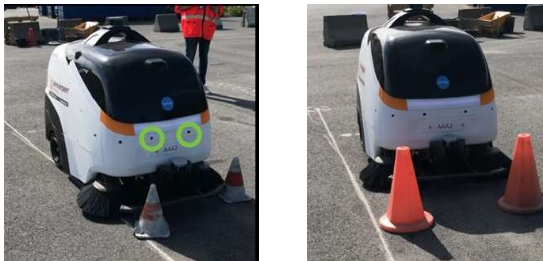
Figur 22: Radarsensorer i bruk i manuell modus (Foto: I. Roche Cerasi).
