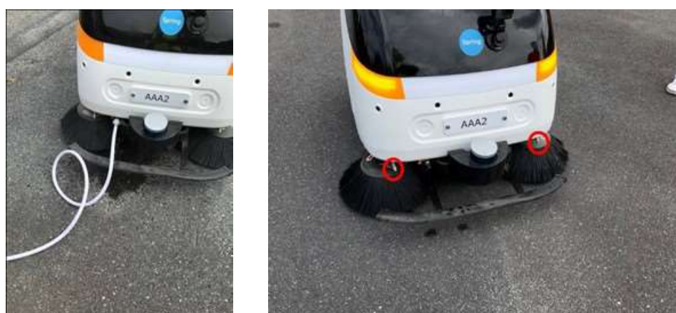
Figur 54: Fylling av vanntank med vaskemaskinsinnløpsslange (Foto: I. Roche Cerasi).
