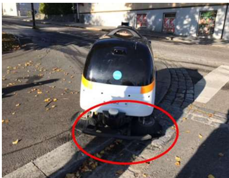
Figur 38: Maskinen kjørte utenfor fortauskanten når den svingte på startpunkt (Foto: I. Roche Cerasi).
