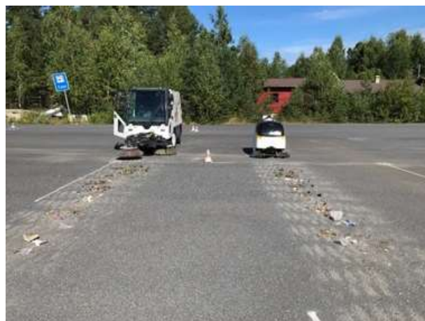
Figur 20: Sammenligningstest med vanlig feiemaskin og Spring S100N (Foto: I. Roche Cerasi).
