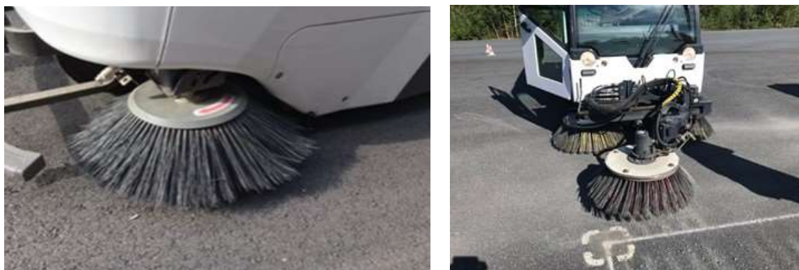
Figur 53: Slitte sidebørster etter testene på Kongsberg (til venstre) og en vanlig feiemaskin (til høyre) (Foto: I. Roche Cerasi).
