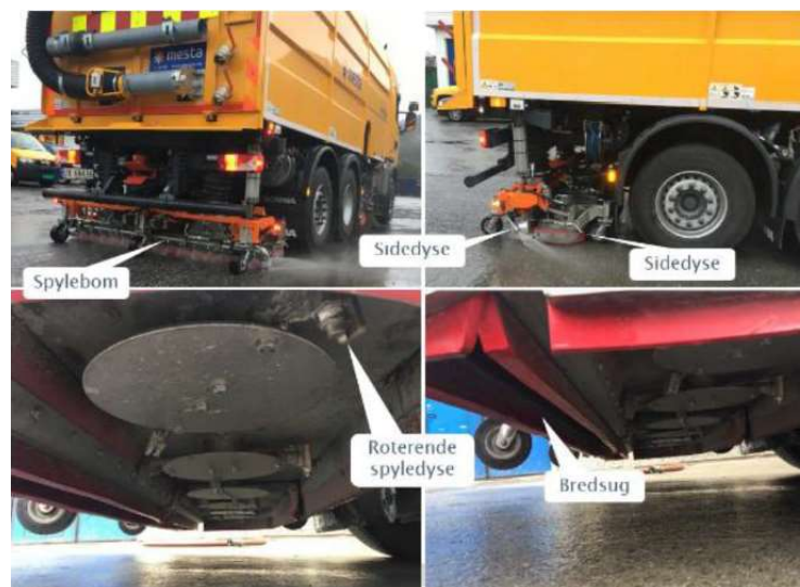
Figur 4 Feiebil med RotorClean-system som består av seks rotorer og bredesug. Kilde: SVV rapport nr. 534.
