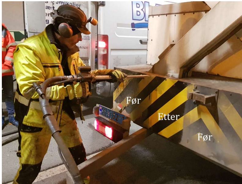
Figur 19 Effekten av tørris på skilt
