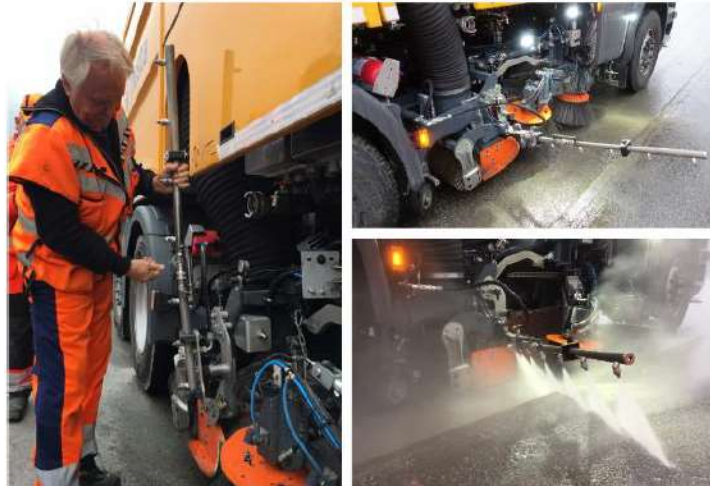
Figur 3 Spylebom med høytrykksdyser på høyre side av feiebil. Kilde: SVV rapport nr.536
