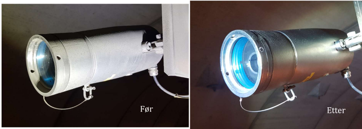
Figur 17 Effekten av tørris på kamera
