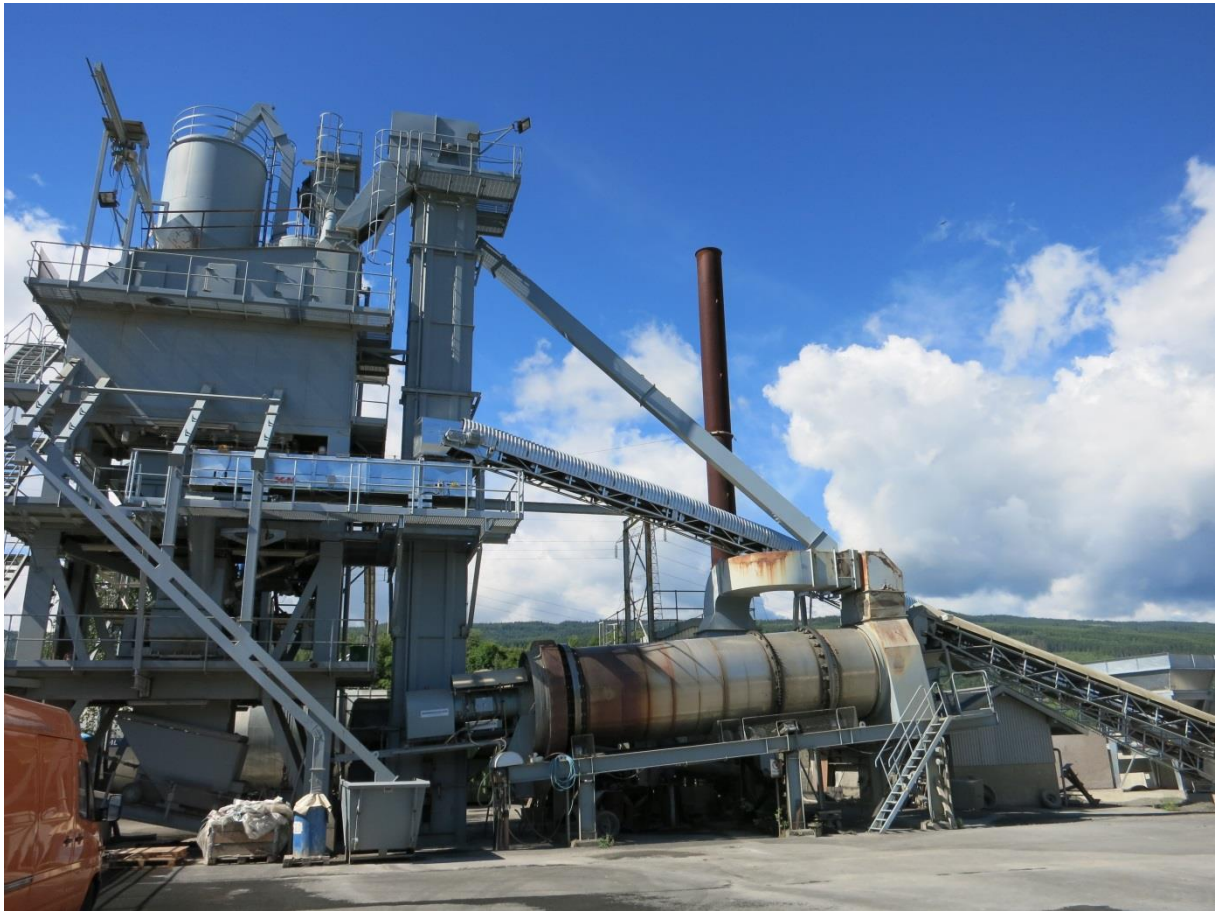
Bilde 9.2 Tilsetting av asfaltgranulat i miksekammeret
