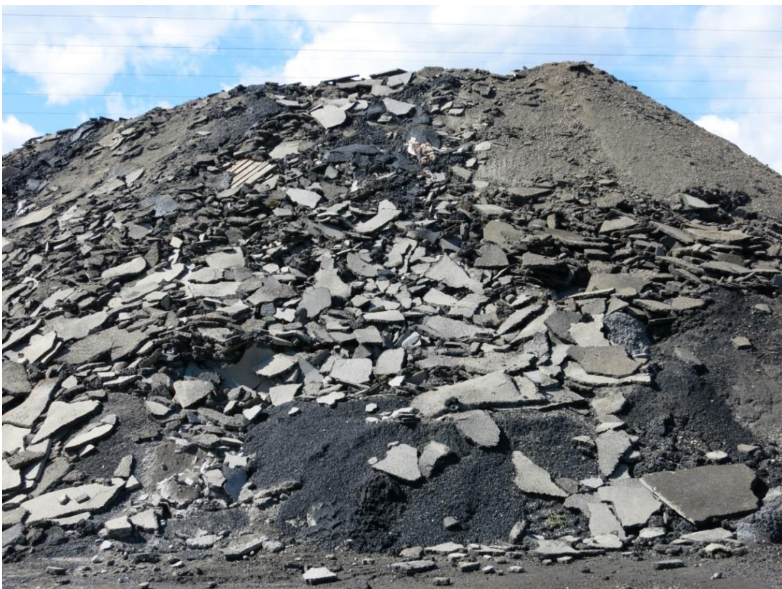
Bilde 6.2. Eksempel på lagerhaug med blanding av asfaltflak, fresemasse og overskuddsmasse
