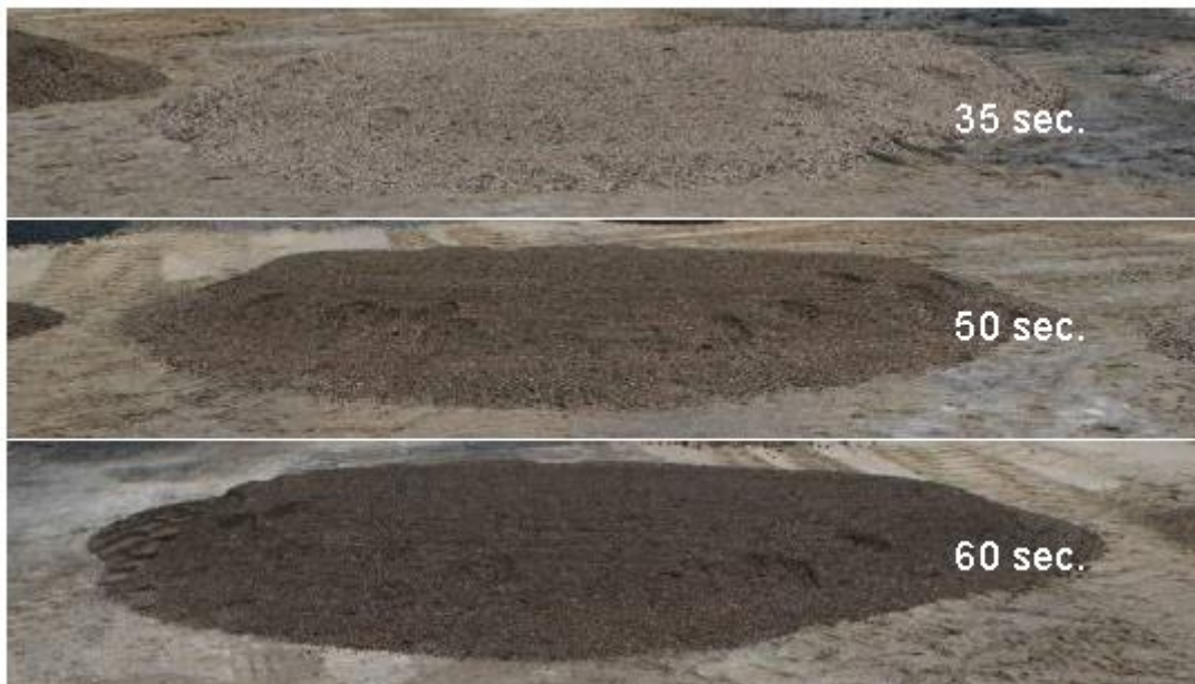
Bilde 9.1: 25 % asfaltgranulat blandet med lyst nytt tilslag for visuell vurdering av fordeling av bindemiddel fra granulatet ved ulike blandetider Ref (19).
