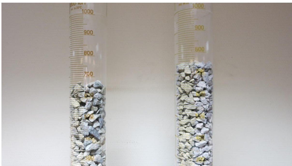
Figur 3: Begge sylindere inneholder 1 kg steinmateriale, sortering 8-11, men med ulik densitet. (Sylinderen til venstre materiale med densitet 3,12 \text{ g/cm}^3 og sylinderen til høyre materiale med densitet 2,65 \text{ g/cm}^3 )
