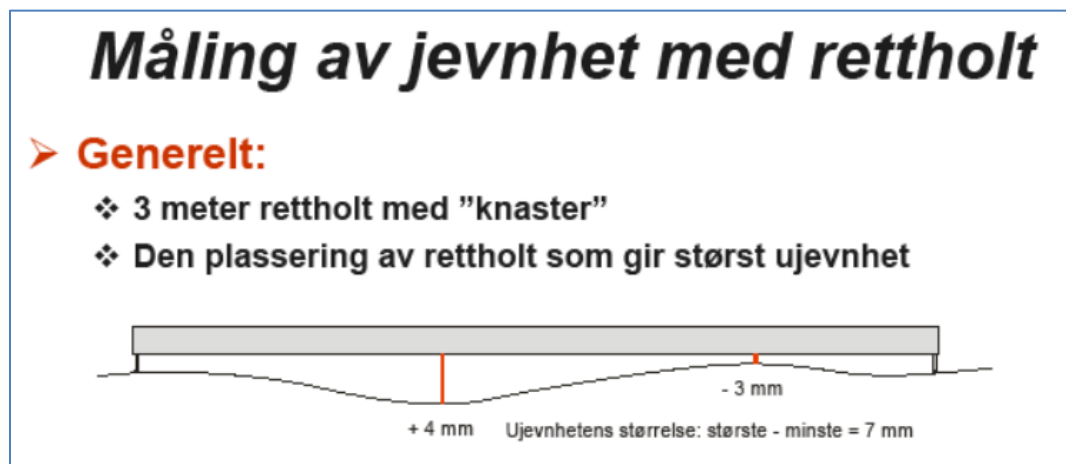
Figur 12: Måling med rettholt med knaster
