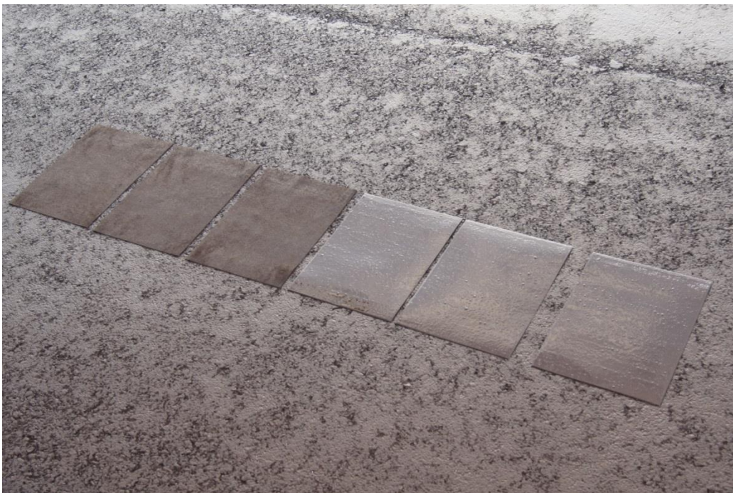
Figur 6: Kontroll av klebemengde. Foto: Wenche Hovin
