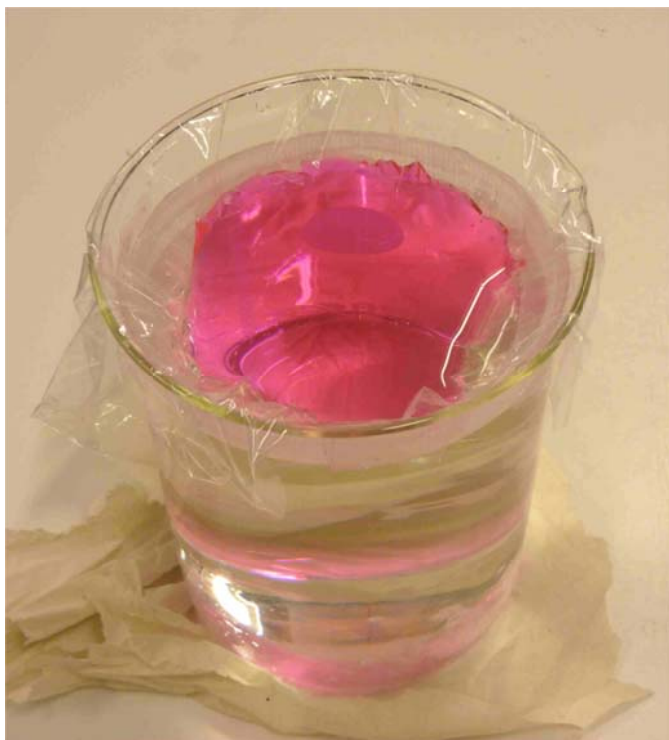
Figur 2. Farget saltløsning påført ovenpå en tynn plastfolie
