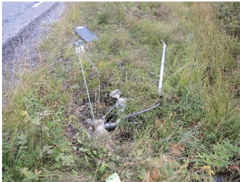
Rustutslag og nedkjørt adapter. Begge foto: Knut Magne Reitan
