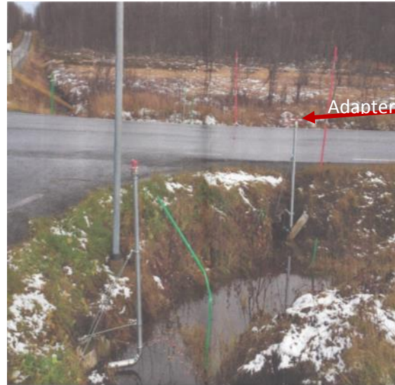
Figur 1. Oppstikk med adapter. Til venstre: adapter for HW1 på fv 737. Foto A Framvik, Mesta
