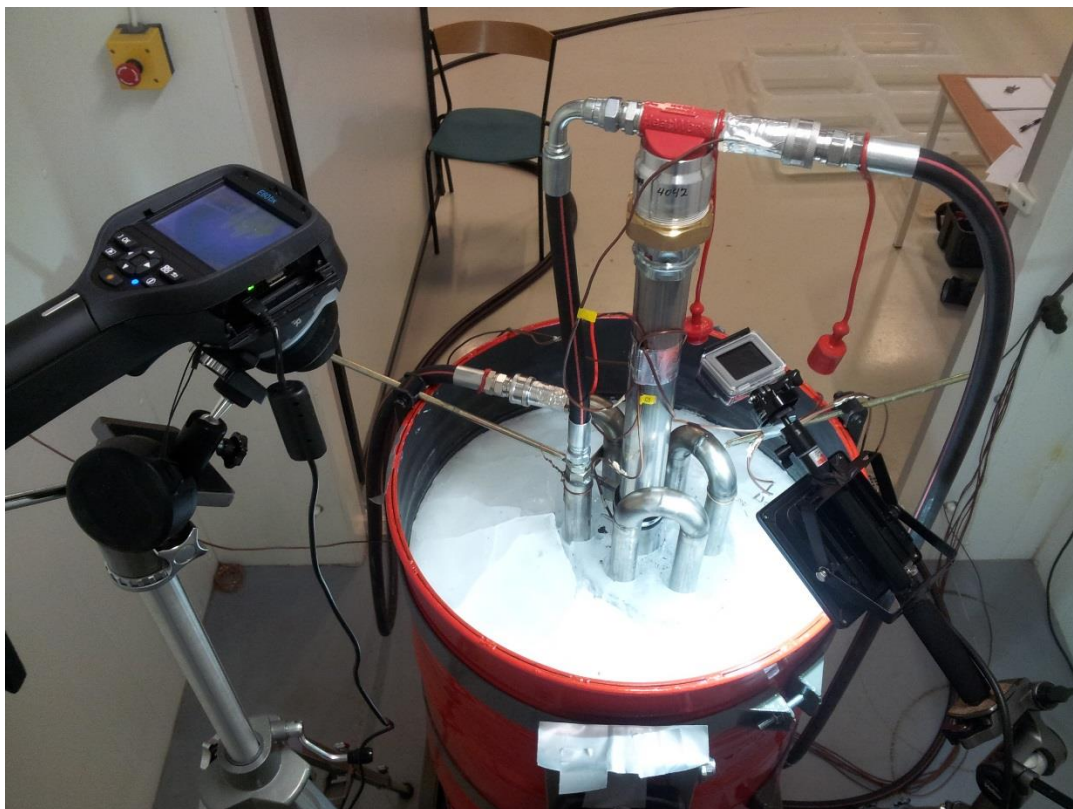
Figur 2.4.2 Måleoppstilling i klimarom II i detalj (sett innenfra), med IR-kamera (til venstre) og time-lapse kamera (til høyre) godt synlig. Innløpsrøret står innefrosset i midten av målekaret.
