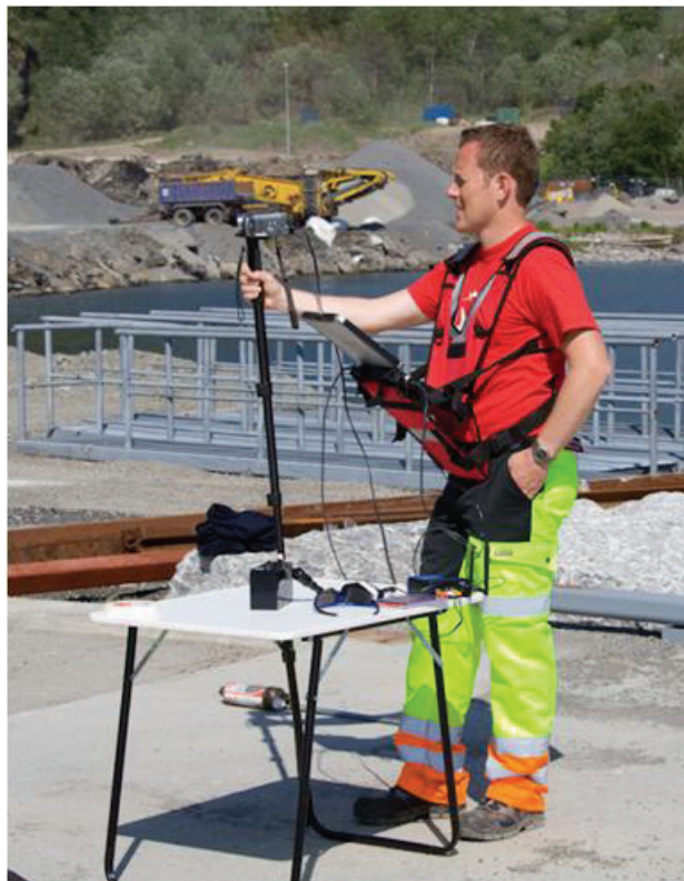
Bilde 4: PIMEX 2008 mottakerenhet (Fotograf Dag Steinar Tønder, Nordasfalt).
