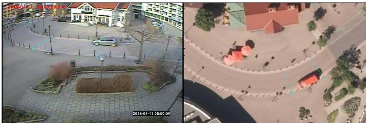
Figur 14. Beregning av fart på kjøretøy på Bekkestua torg ved hjelp av imaginære linjer i vegbanen. Bildet til høyre er hentet fra Finn kart, bildet til venstre viser hvordan dette er tegnet inn i kamerabildet.
