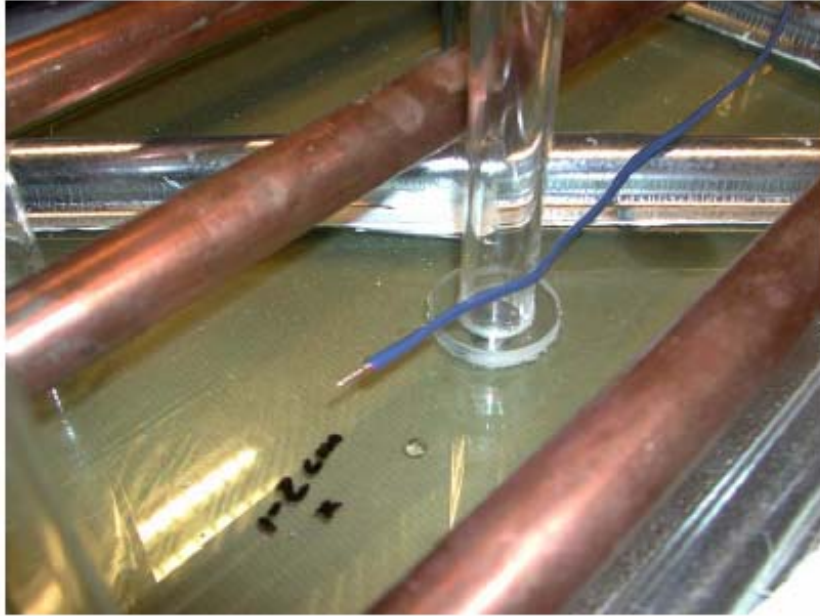
Figur 5. Termoelement for overvåking av temperaturutvikling i glassene under forsøket.
