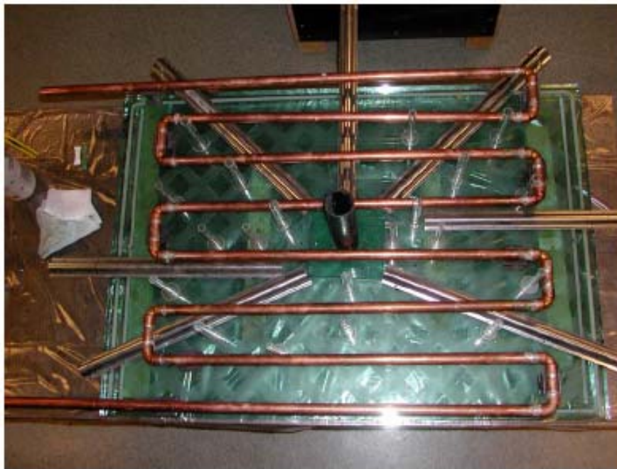
Figur 4. Glassplate med kjølerør klar til innstøping.
