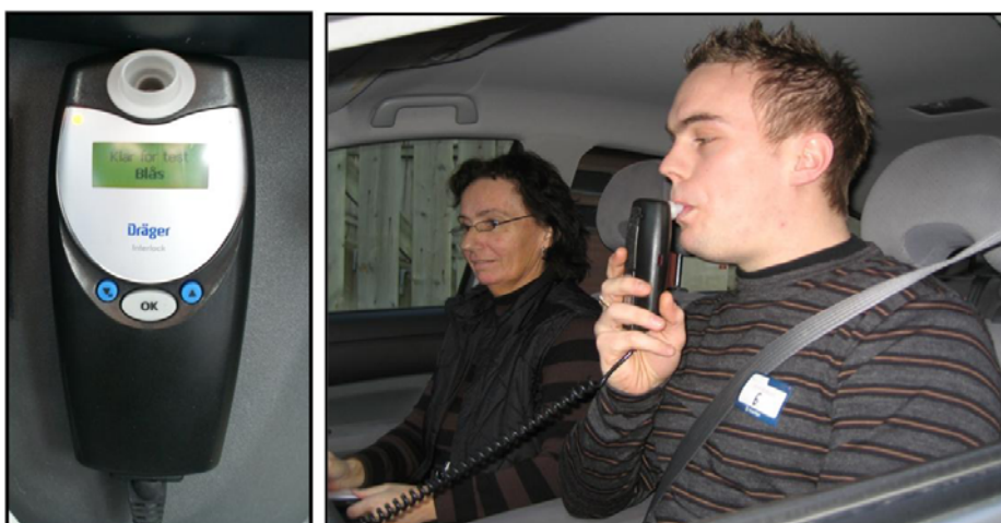
Figur 6: Bildet viser sjåfør som foretar blåseprøve med alkolås (foto: SINTEF).
