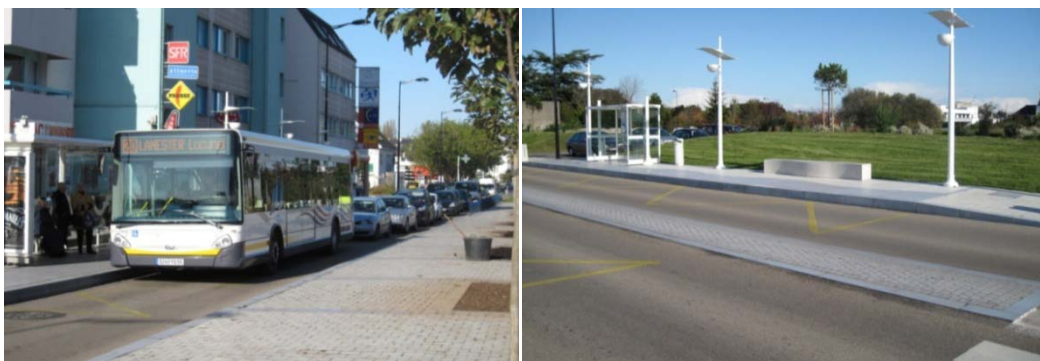
Figur 38. I Lorient har bussen egen trase som er oppmerket med gult ved alle holdeplasser. Bilene må vente bak bussen til den har kjørt fra holdeplass (Foto: T. Loftsgarden).
