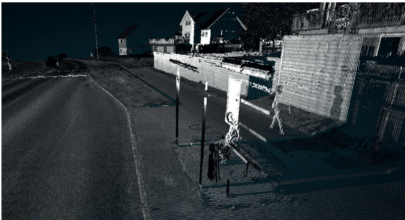
Figur 8: Mangel på holdeplasskilt og armlener i laserdata. Astronomvegen, til sentrum (holdeplass 6). Foto: Statens vegvesen.
